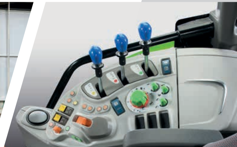
> Ergonomische lay-out van de bedieningselementen van de achterhef en de hydrauliek.
