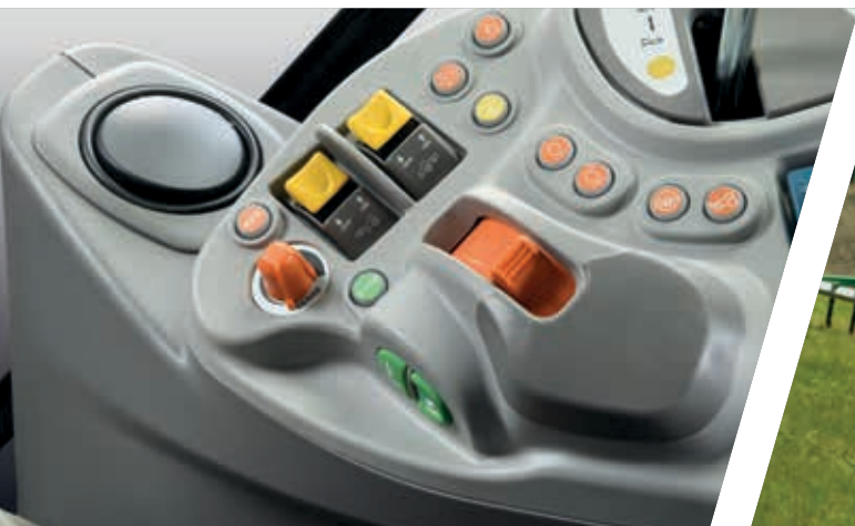
> Elektrohydraulisch ingeschakelde front- en achter-PTO's en Auto PTO-functie.
