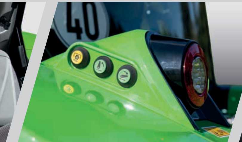
> Externe bedieningselementen voor de achterhef en PTO.
