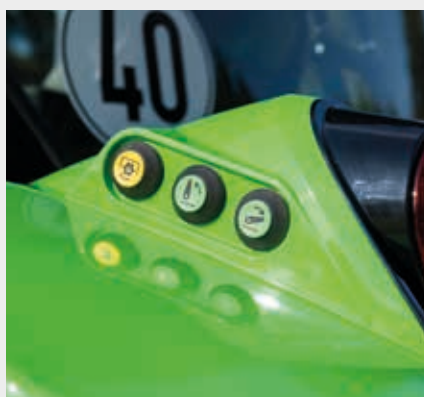
↑ Externe bedieningselementen voor de achterhef en PTO.
