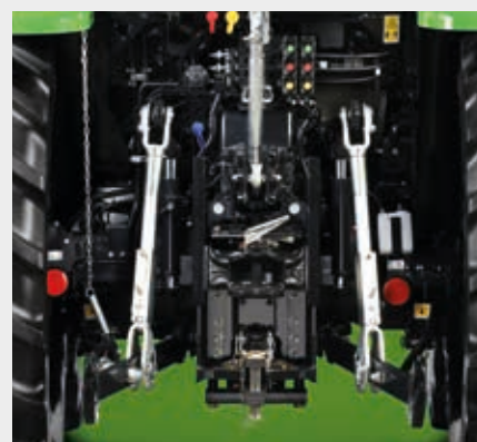
↑ Hendels van de achterhef en de hydrauliekventielen.
