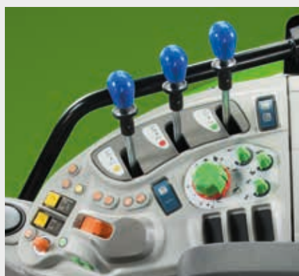
↑ Ergonomische lay-out van de bedieningselementen van de achterhef en de hydrauliek
