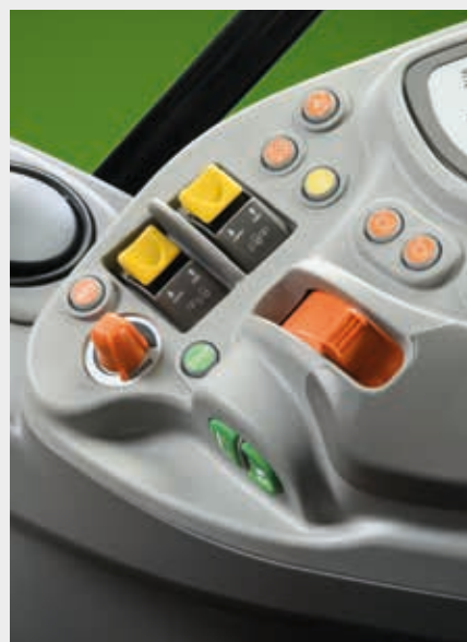
↑ Elektrohydraulisch ingeschakelde front- en achter-PTO's en AUTO PTO-functie.
