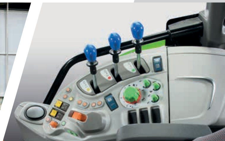
> Ergonomiczne rozmieszczenie elementów sterowania tylnego podnośnika.
