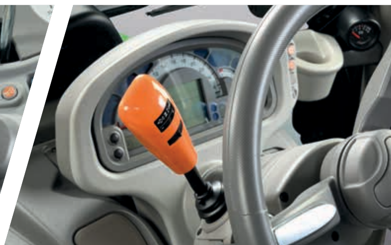
> Inversor eletro-hidráulico (PowerShuttle) com reatividade ajustável.
