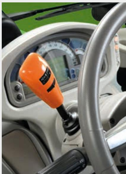
↑ Inversor eletro-hidráulico (Powershuttle) com reatividade ajustável.
