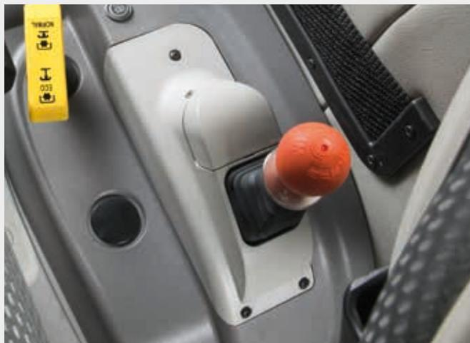
↑ HPB (travão de estacionamento hidráulico)
