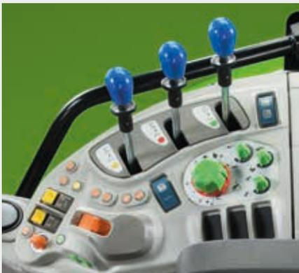
↑ Disposição ergonômica dos comandos do elevador traseiro e sistema hidráulico
