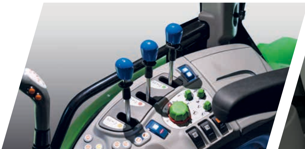
> Rechte Konsole mit Hintergrundbeleuchtung für optimale Sicht auch bei Nacht.
