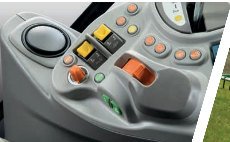
> Elektrohydraulische Zuschaltung der Front- und Heckzapfwelle und Zapfwellenautomatik.
