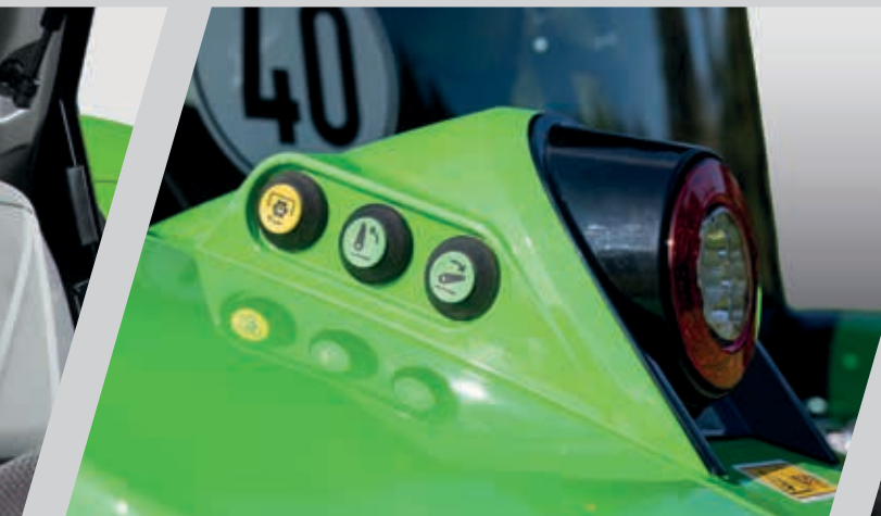
> Externe Bedienung für Heckkraftheber und Zapfwelle.
