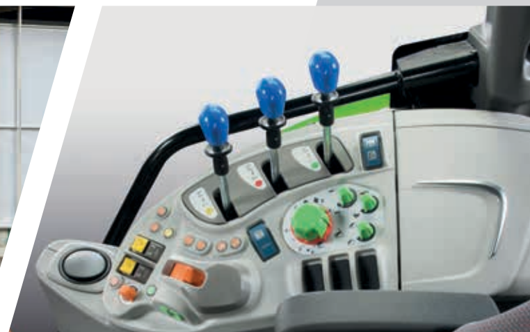
> Ergonomische Anordnung der Bedienelemente für Heckkraftheber und Steuerventile.
