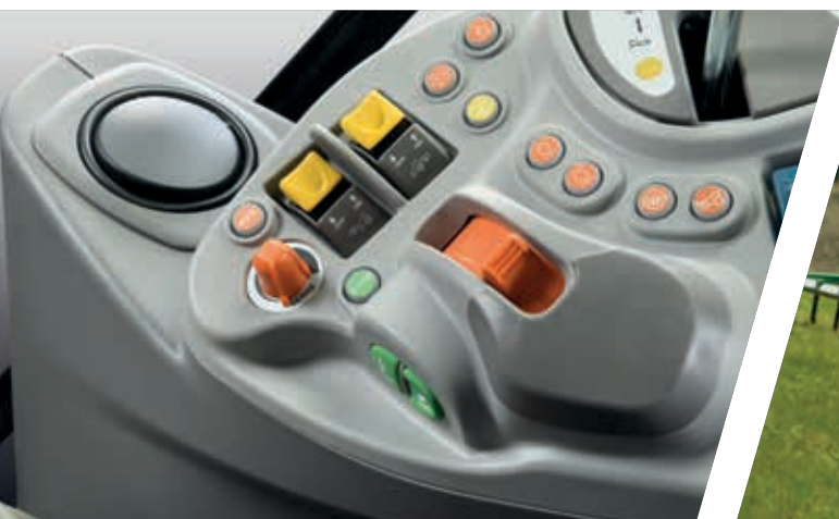
> PDF avant et arrière à engagement électrohydraulique et fonction PDF Auto.
