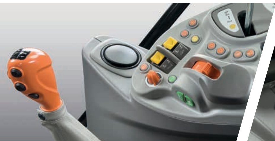
> Commandes de transmission Powershift et gestion APS.
