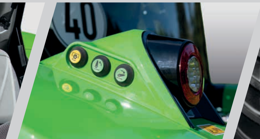
> Commandes extérieures du relevage arrière et de la PDF.
