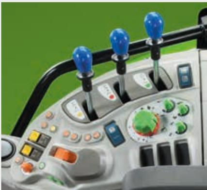
↑ Disposizione ergonomica dei comandi del sollevatore posteriore e delle funzioni idrauliche.
