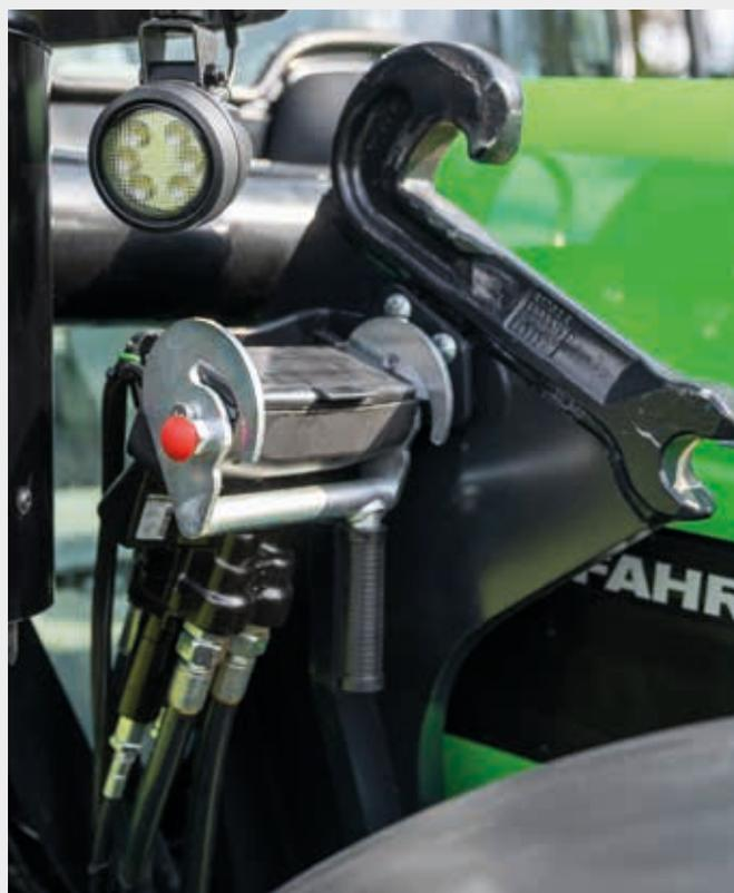
↑ Telaio fisso con caricatore frontale con connessione Hydro-Fix.
