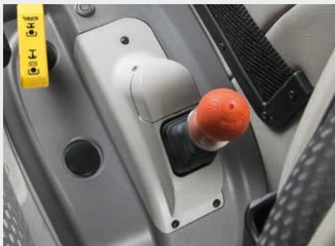
↑ HPB (Hydraulic Parking Brake, freno di stazionamento idraulico).
