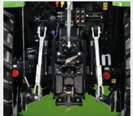
↑ Leve sollevatore posteriore e uscite idrauliche.
