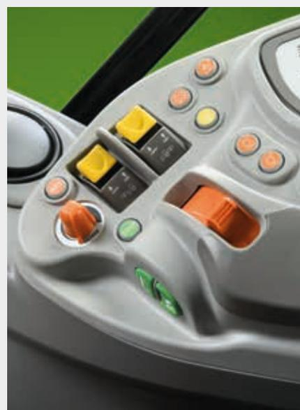
↑ PTO anteriore e posteriore ad innesto elettroidraulico e funzione Auto PTO.
