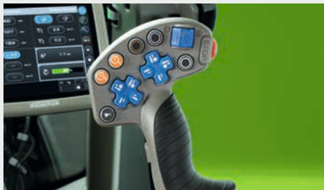
↑ Joystick MaxCom umożliwia łatwą obsługę przekładni TTV.
