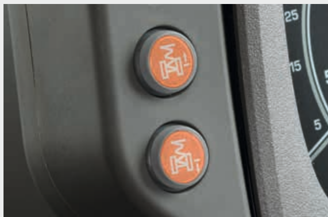
↑ Dwa nowe, dedykowane przyciski umożliwiające ręczną regulację położenia przedniego zawieszenia.
