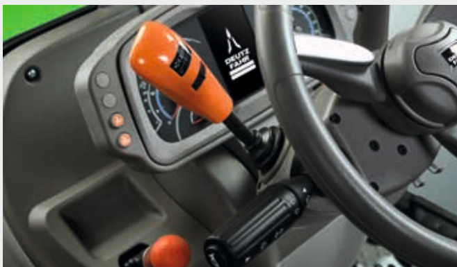
↑ SenseClutch: możliwość konfiguracji reakcji rewersu.
