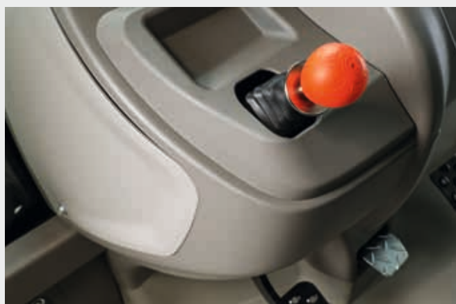
↑ Bezpieczne parkowanie nawet w terenie górzystym dzięki mocnemu hamulcowi postojowemu HPB.
