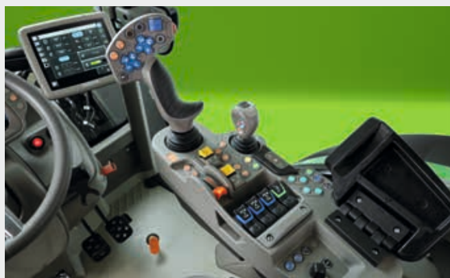
↑ Podłokietnik MaxCom z intuicyjnie rozmieszczonymi sterownikami.
