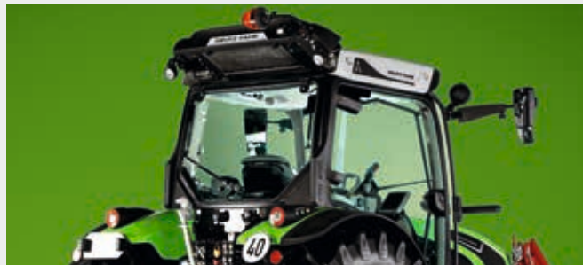
↑ Tylny podnoszony dach, czyli najwyższa widoczność z tyłu do góry.
