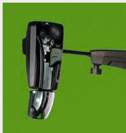
↑ Lusterka z elektryczną regulacją i ogrzewaniem.
