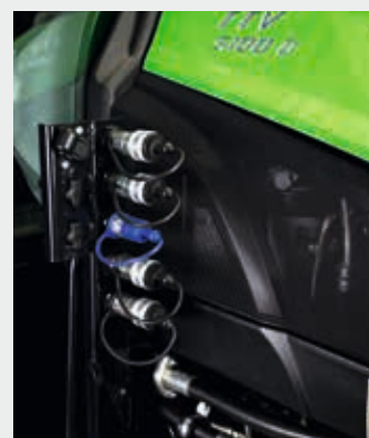
⬆ Obwody hydrauliczne montowane centralnie do maszyn przednich.
