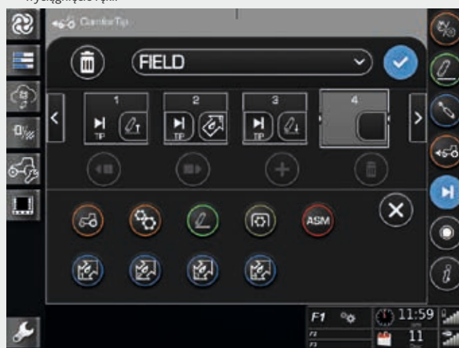
↑ Comfortip dodatkowo zwiększa poziom komfortu. Umożliwia zapisywanie w pamięci powtarzanych zadań oraz ich wywołanie przez naciśnięcie przycisku.
