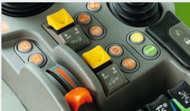
↑ łatwe załączanie przedniego i tylnego WOM przyciskami na podłokietniku MaxCom.
