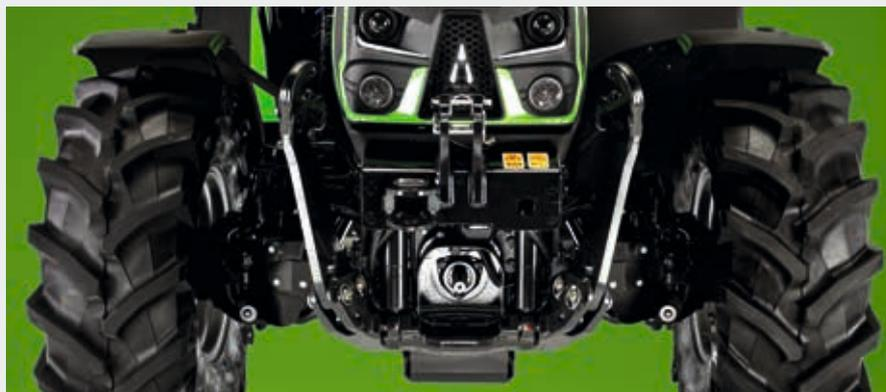
↑ Les modèles 5D TTV peuvent être équipés d'un relevage avant d'une capacité de 2 100 kg et d'un pack confort en option.
