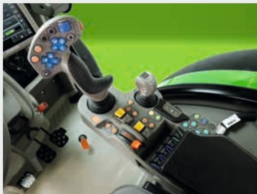
↑ Distributeur facilement contrôlable par joystick et du bout des doigts.
