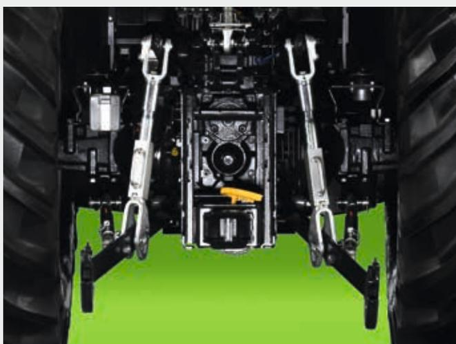
↑ Relevage arrière standard pour plus de capacité.
