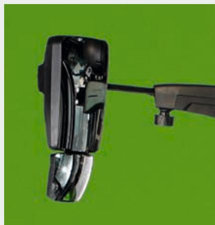
↑ Rétroviseurs à réglage et dégivrage électriques.
