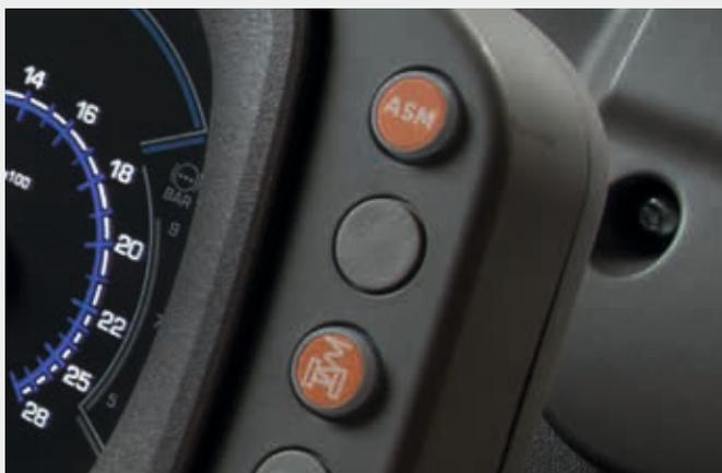
↑ ASM et activation de la suspension du pont avant.
