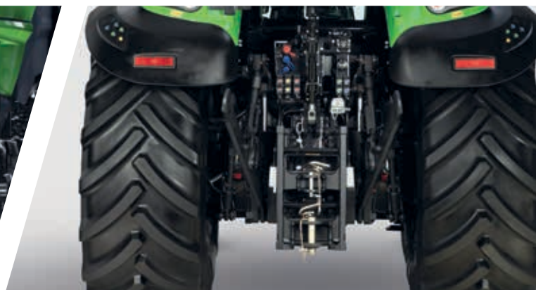
> Hefinrichting achter, vijf hydraulische ventielen achter, externe bedieningselementen op spatborden aan beide zijden.
