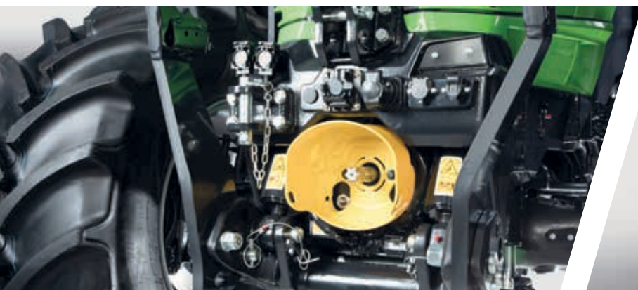
> Fronthefinrichting met 5450 kg hefvermogen en DualSpeed voor-PTO.
