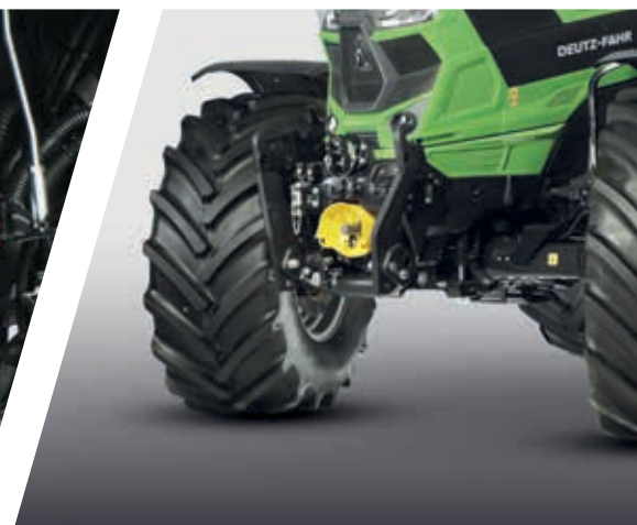
> Concept voorwielophanging met grote vrije hoogte onderaan voor een uitstekende stabiliteit in wisselende omstandigheden.
