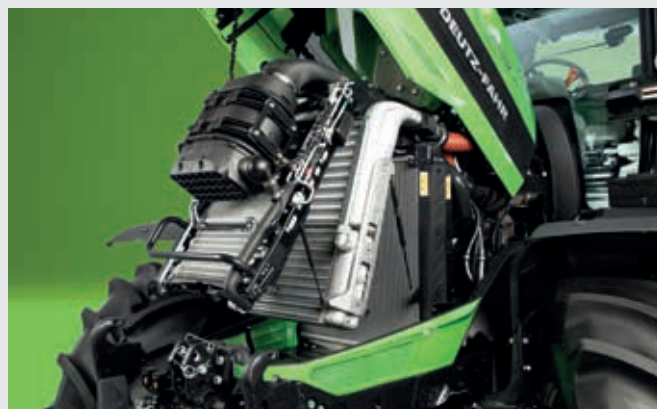
Aluminium koelsysteem met openklapbaar met 1 hand en Powercore luchtfilter.
