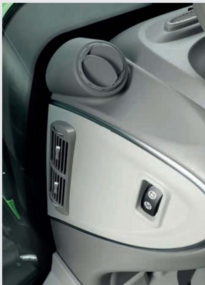
Extra luchtuitlaten en accuhoofdschakelaar comfortabel in de cabine geplaatst.
