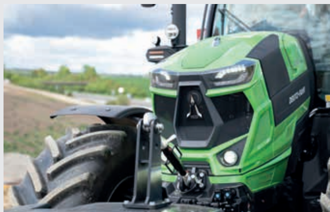
↑ Led-rijverlichting en karakteristieke ledwerkklampen.
