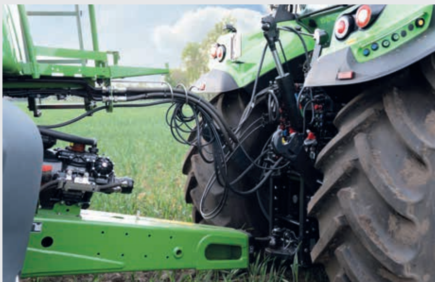
⬆ Hefinrichting achter in transportstand voor minder contact met trekstangen in bochten.
