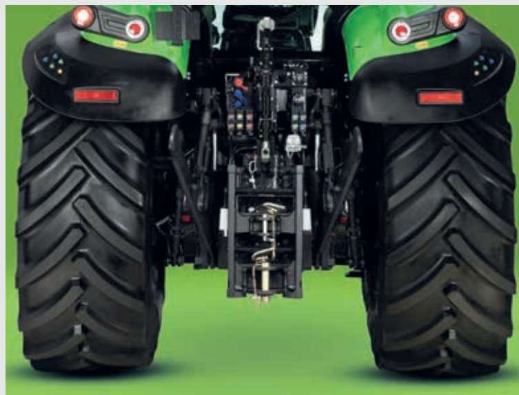
↑ Hefinrichting achter, vijf ventielen achter, externe bedieningselementen op spatborden aan beide zijden.
