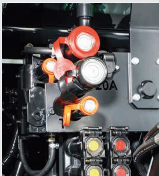
⬆ Power Beyond met vlakke koppelingen voor een schone verbinding.
