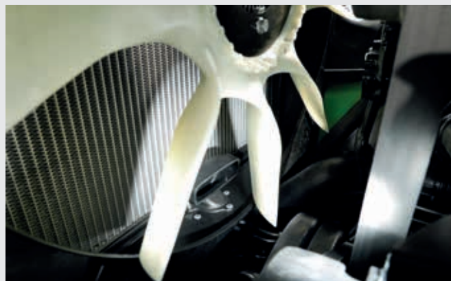
Elektronische viscostatische ventilator (eVisco) met aanzuigslang voor het voorreinigingssysteem van het luchtfilter.
