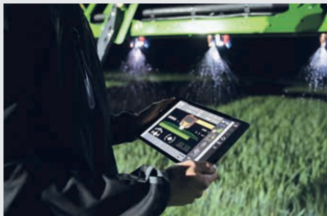
↑ XTEND-functie met tablet, werktuigbediening via ISOBUS UT van buiten de cabine.
