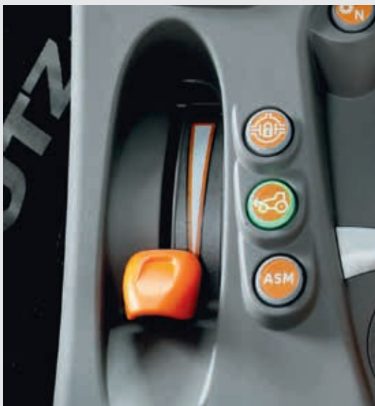
↑ Onafhankelijk handgas en elektrohydraulische activering van de differentieelblokkering, vierwielaandrijving en automatische ASM-functie.
