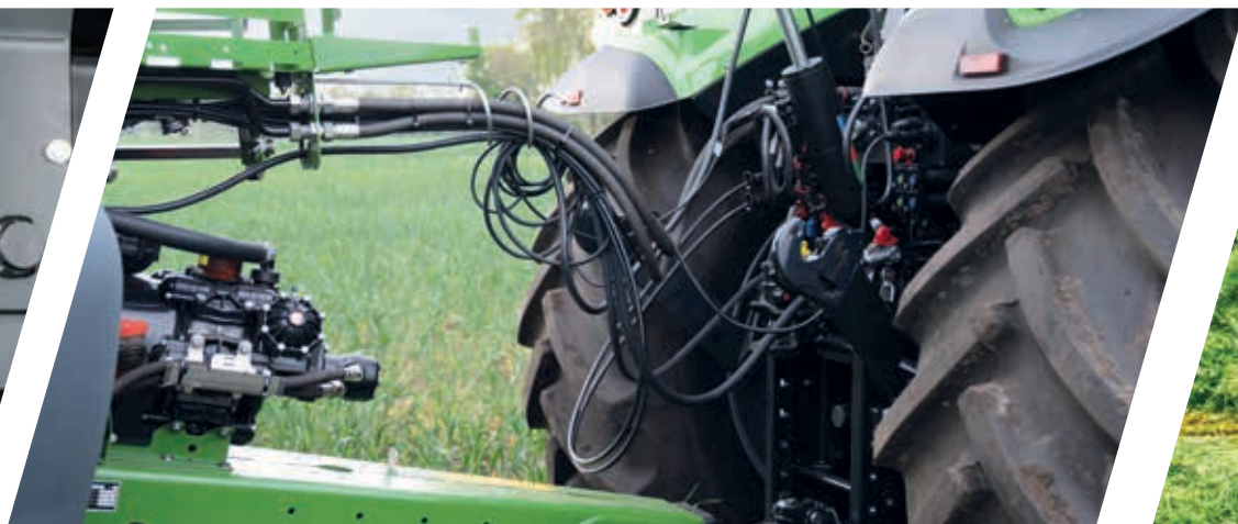
> Tylony podnośnik z ramionami w pozycji transportowej, w której nie kolidują z dyszlami podczas skręcania.
