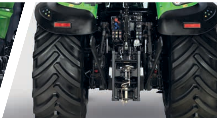
> Tylony podnośnik, pięć tylnych obwodów hydrauliki, przyciski na błotnikach do sterowania umieszczone z obu stron.
