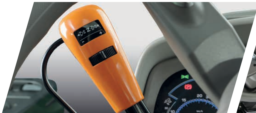
> PowerShuttle ze sprzęgłem Sense Clutch oraz pięć ustawień zmiany kierunku.
