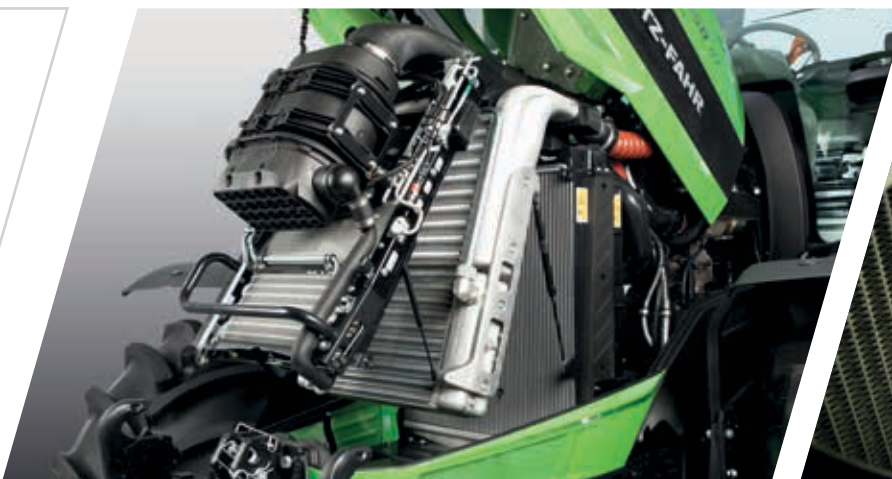
> Aluminiowy układ chłodzenia z dźwignią blokady obsługiwanej jedną ręką oraz filtrem powietrza Powercore.
