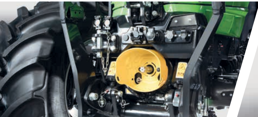
> Frontkraftheber mit 5450 kg Hubkraft und DualSpeed-Frontzapfwelle.
