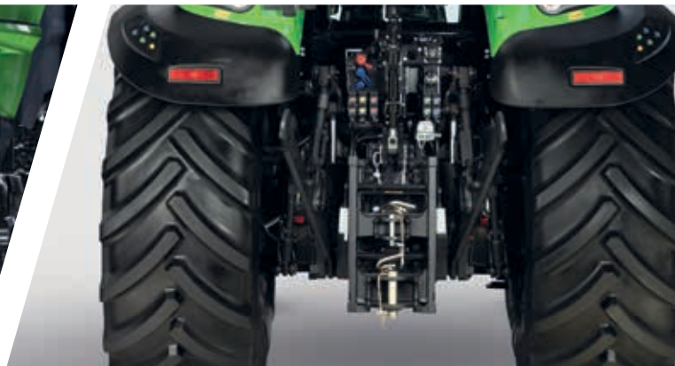
> Heckkraftheber, fünf Hecksteuergeräte, externe Bedienelemente an den Kotflügeln auf beiden Seiten.
