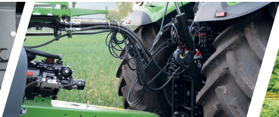
> Heckkraftheber mit Transportstellung – keine Kollision mit Anbaugeräten in der K80-Anhängung bei Kurvenfahrten.
