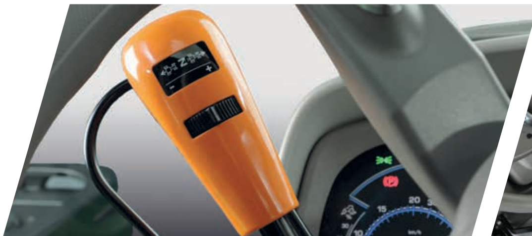
> PowerShuttle con SenseClutch y cinco ajustes de agresividad de cambio de dirección.
