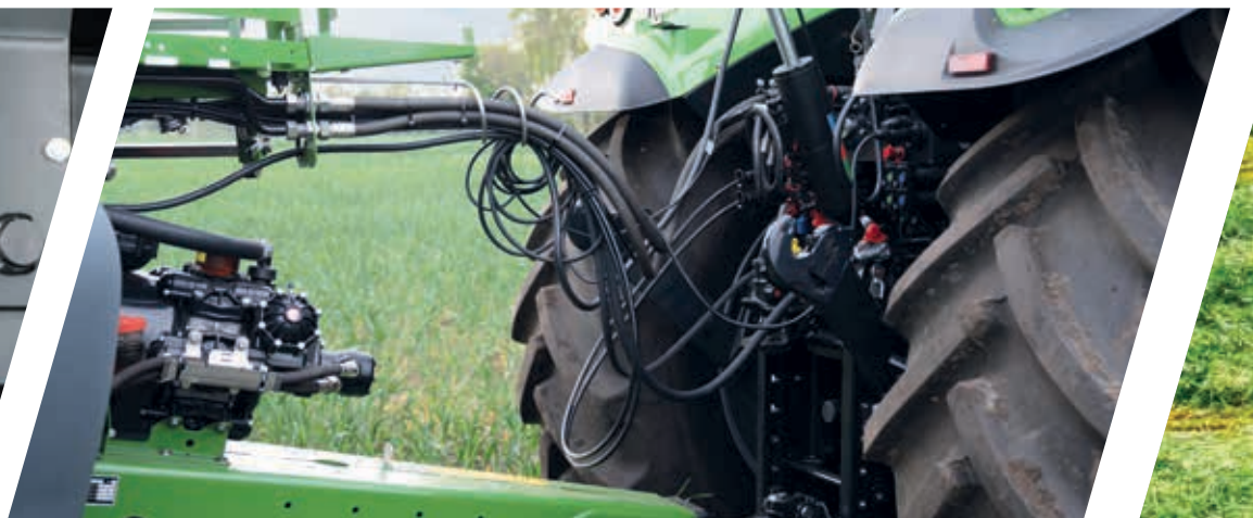
> Elevador trasero en posición de transporte para una menor interferencia con las barras de tracción en las curvas.
