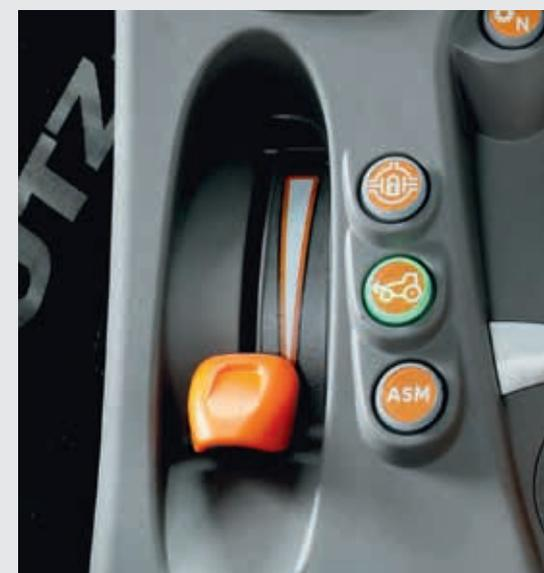
↑ Acelerador de mano independiente y activación electrohidráulica del bloqueo del diferencial, tracción a las cuatro ruedas y función automática ASM.
