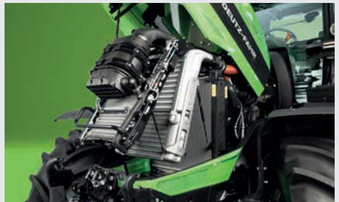
Sistema de refrigeración en aluminio con palanca de acceso, accionable con una mano, y filtro de aire Powercore.
