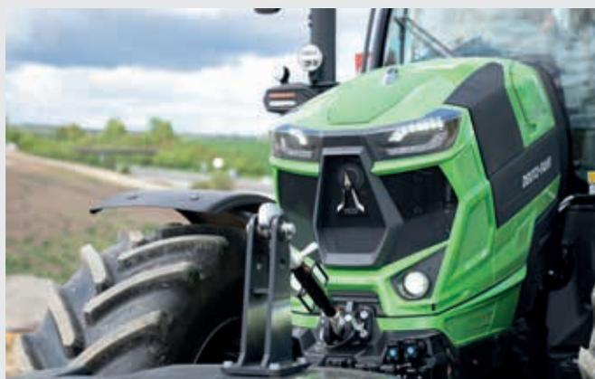
↑ Luces de conducción LED y faros de trabajo LED.
