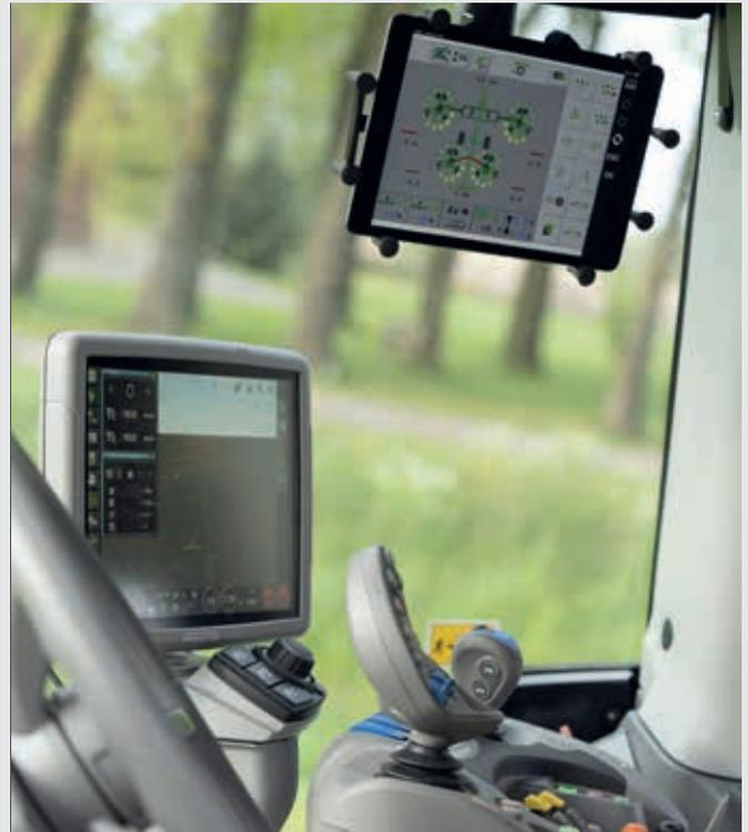
La función XTEND permite visualizar SDF Guidance o controlar un implemento ISOBUS en un dispositivo externo, por ejemplo, una tablet.
