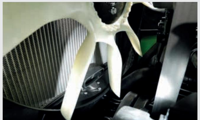
Ventilador electrónico (eVisco) con sistema de prelimpieza del filtro del aire por aspiración.
