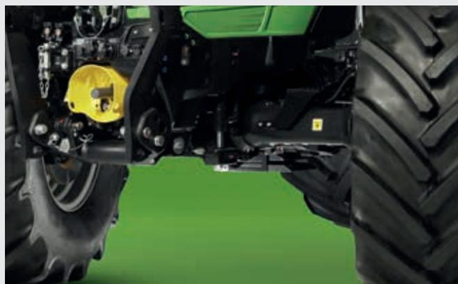
↑ Concepto de suspensión delantera con gran despeje y tres niveles de regulación en el InfoCenter<sup>PRO</sup>.
