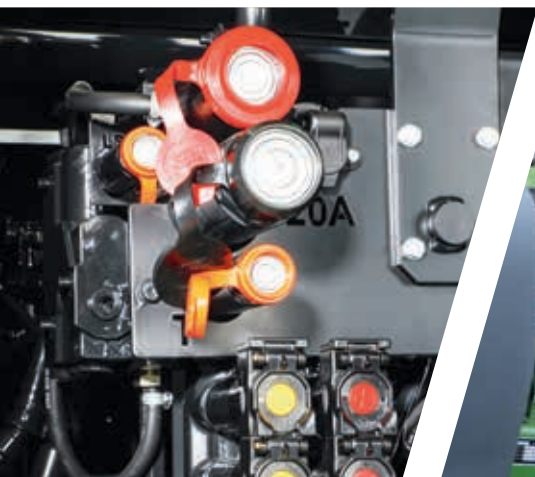
> Power Beyond avec des coupleurs à face plate pour une connexion propre.
