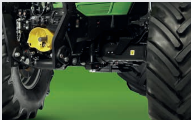
↑ Concept de suspension avant avec une garde au sol élevée et 3 niveaux réglables dans l'InfoCenter PRO .
