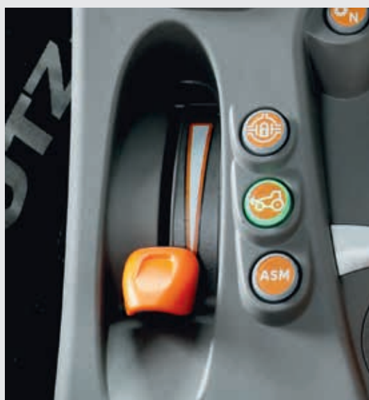
↑ Accélérateur manuel indépendant et activation électrohydraulique du blocage de différentiel, des 4RM et de la fonction automatique ASM.
