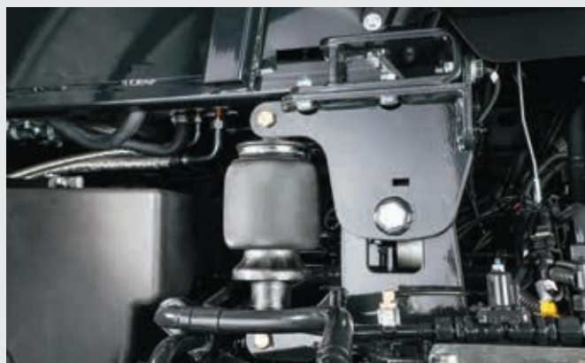
↑ Cabine à suspension pneumatique pour un confort de conduite maximal.
