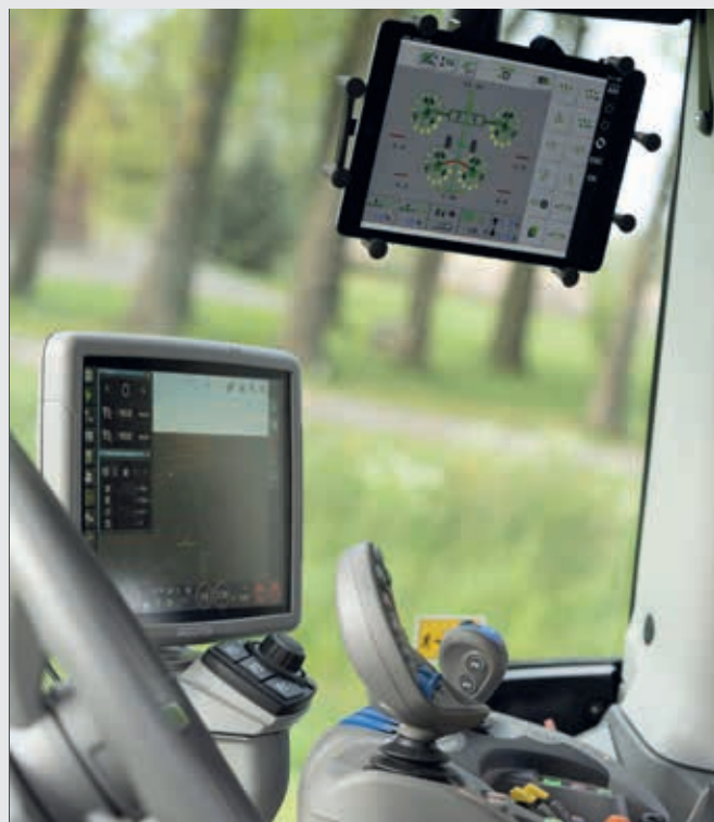
↑ La fonction XTEND permet d'afficher SDF Guidance ou de contrôler un outil ISOBUS sur un dispositif externe, par exemple une tablette.
