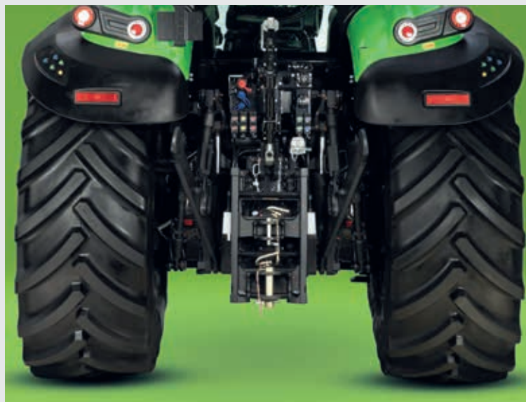
↑ Attelage arrière, cinq distributeurs arrière, commandes externes sur les ailes des deux côtés.
