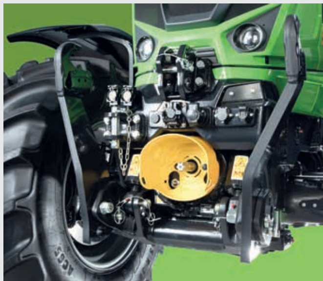
↑ Relevage avant avec capacité de relevage de 5 450 kg et prise de force avant DualSpeed.
