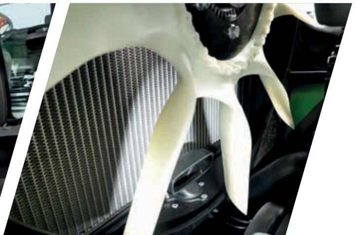
> Hava filtresi ön temizleme sistemi için emme hortumuna sahip elektronik viskostatik fan (eVisco).
