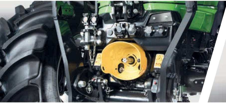
> 5450 kg kaldırma kapasitesine sahip ön kaldırıcı ve DualSpeed ön PTO.
