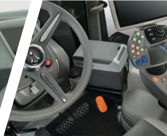
> Ön ve arka kaldırıcı, motor, şanzıman, sürülmemiş arazi ve iki oransal hidrolik valf kontrol birimi ile ergonomik MaxCom kumanda kolu.
