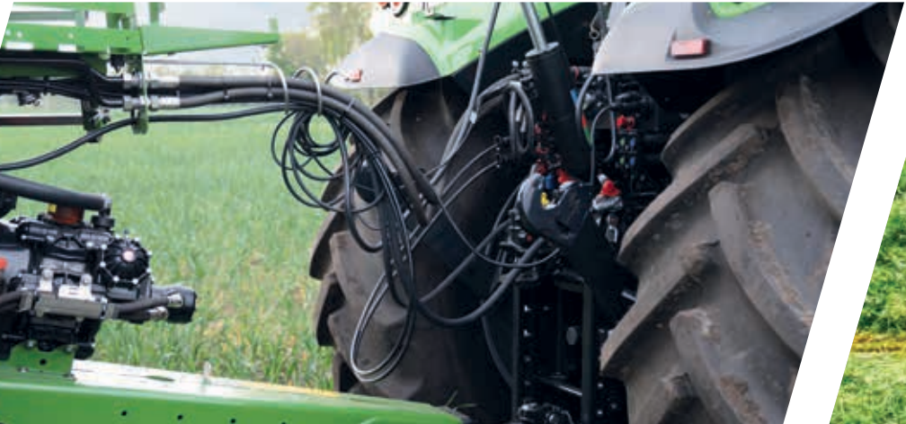
> Viraj alırken çeki çubukları ile daha az çakışma için taşıma konumunda arka bağlantı.
