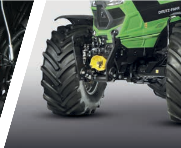
> Değişken koşullarda olağanüstü denge için yerden yüksek ön süspansiyon konsepti.
