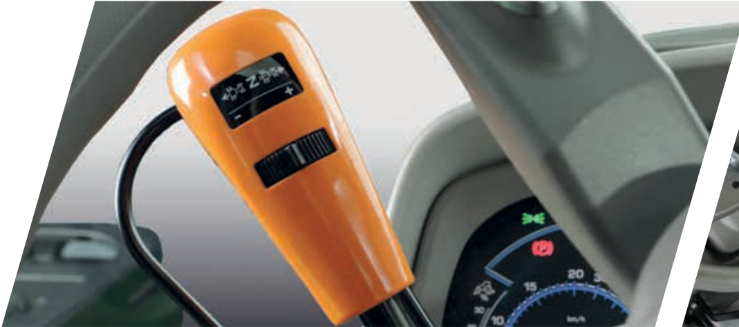
> Sense Clutch ve beş kademeli yön değiştirme ayarı özelliğine sahip PowerShuttle.
