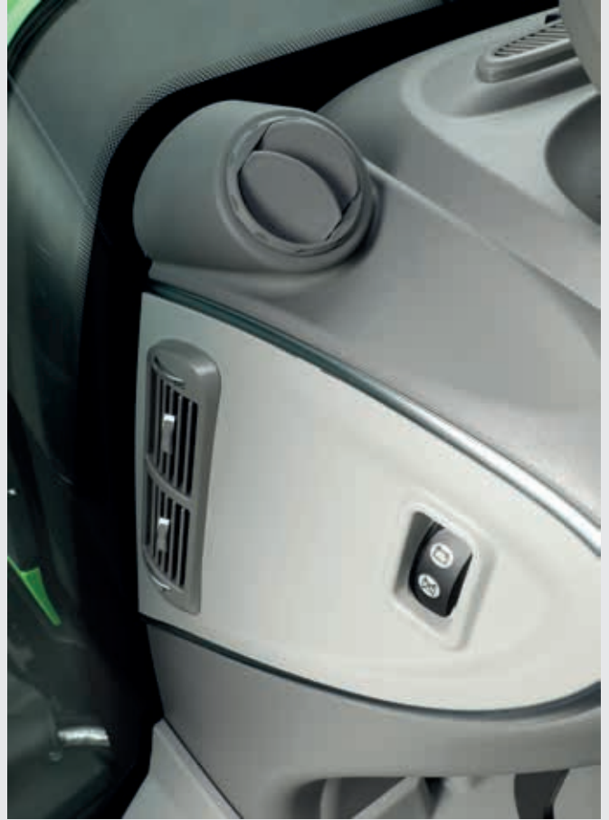
Kabine konforlu şekilde yerleştirilmiş akü ana şalteri ve ilave hava çıkışları.
