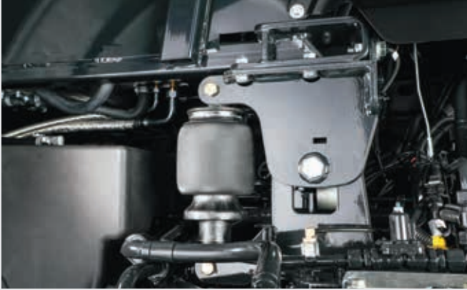
↑ Maksimum sürüş konforu için hava süspansiyonlu kabin.
