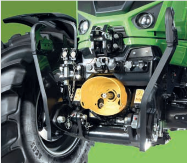
↑ 5.450 kg kaldırma kapasitesi ve DualSpeed ön PTO'ya sahip ön kaldırıcı.
