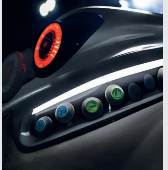
Dış kontrolleri aydınlatan LED lamba şeridi.
