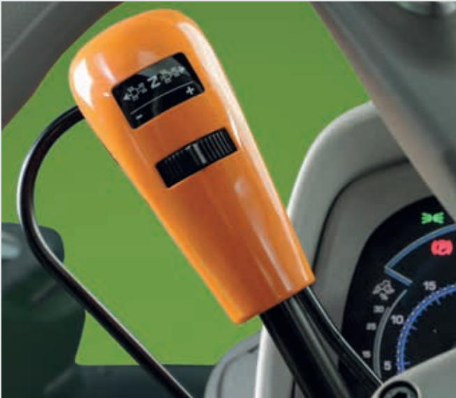
↑ Sense Clutch ve beş yön değiştirme ayarı ile PowerShuttle.
