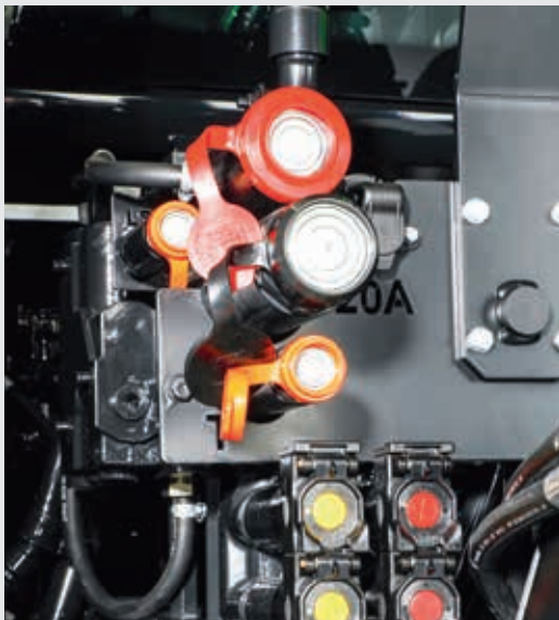
↑ Temiz bir bağlantı için düz yüzeyli kuplörler ile Power Beyond.
