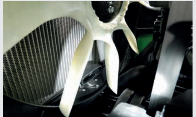
Hava filtresi ön temizleme sistemine yönelik emme hortumuna sahip elektronik viskostatik fan (eVisco).
