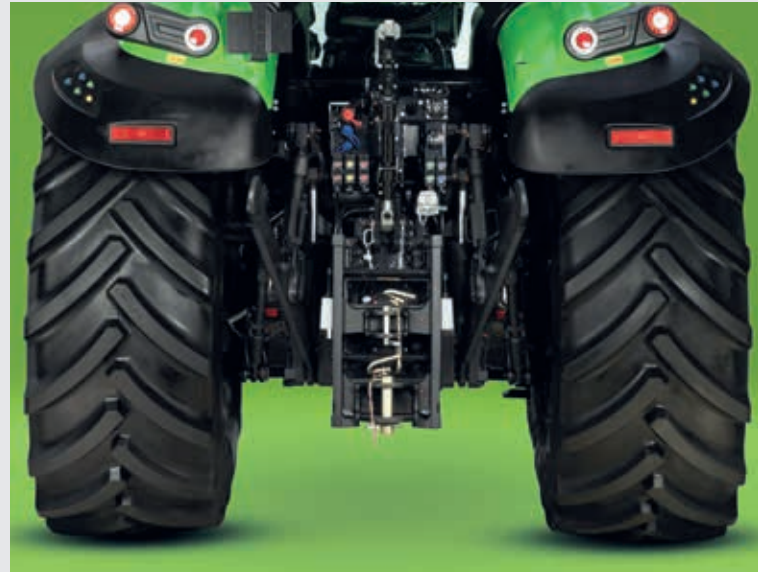
↑ Her iki taraftaki çamurluklarda dış kontrollörler, beş adet arka makara valfi, arka bağlantı.
