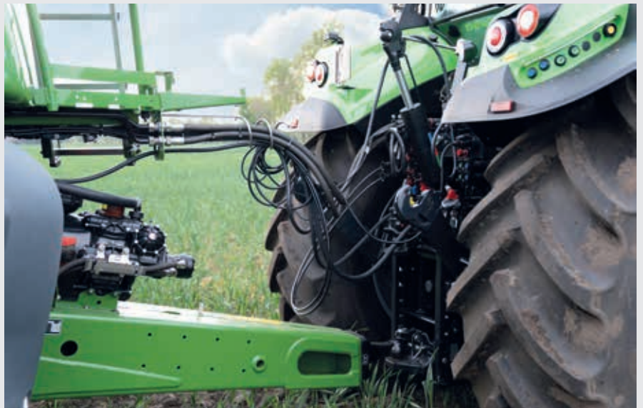
↑ Viraj alırken çeki çubukları ile daha az çakışma için taşıma konumunda arka bağlantı.
