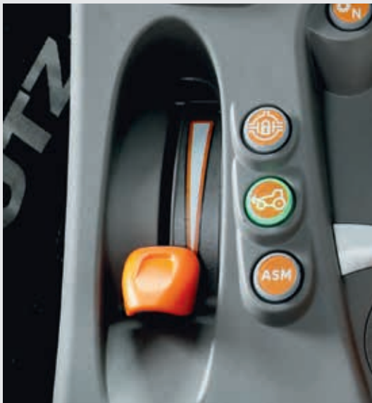
↑ Bağımsız el gazı ve diferansiyel kilidinin elektrohidrolik etkinleşmesi, tüm tekerleklerden çekiş ve ASM otomatik işlevi.
