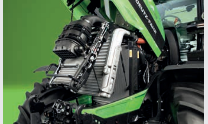
Tek elle erişim koluna ve Powercore hava filtresine sahip alüminyum soğutma sistemi.
