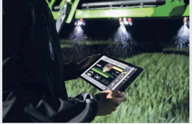
↑ Tablet ile XTEND işlevi, kabin dışındayken ISOBUS UT aracılığıyla tarımsal ekipmanların kontrolü.
