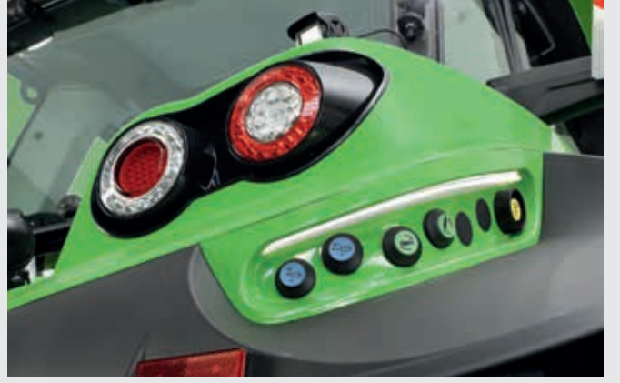
Her iki tarafta LED lamba çubuğuyla ışıklandırılmış çamurluk kontrolleri.
