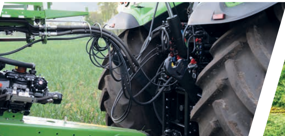
> Sollevatore posteriore in posizione di trasporto per una minore interferenza con le barre di traino in fase di sterzata.
