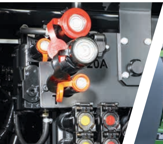
> Power Beyond con raccordi con superficie di accoppiamento piatta per semplicità di collegamento.
