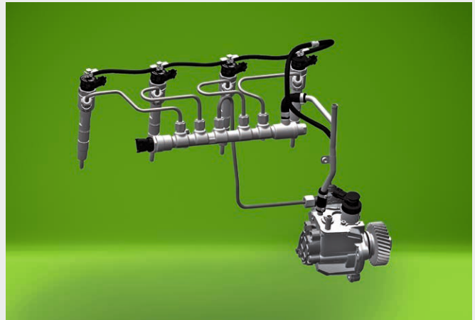
↑ Common-Rail-Einspritzanlage mit 2.000 bar Einspritzdruck.
