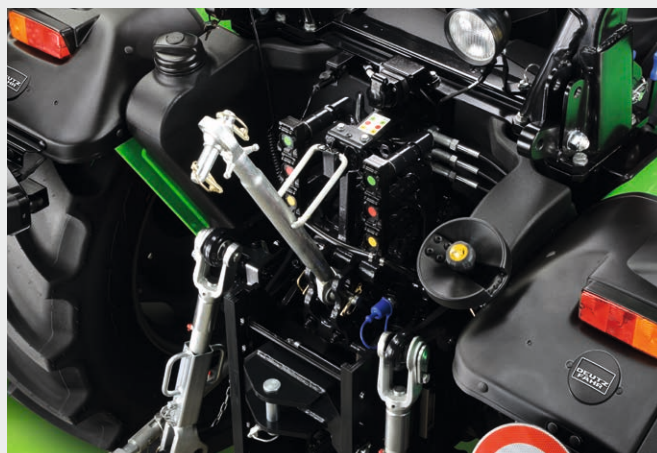
Die Hydraulikpumpe mit einer Fördermenge von 55 l/min versorgt bis zu drei Steuergeräte im Heck.
