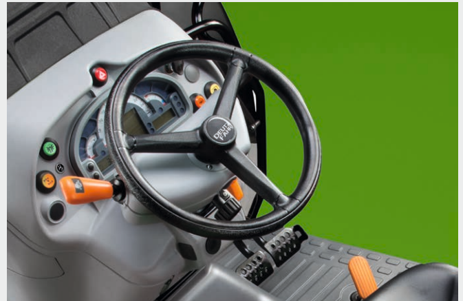
↑ Das innovative SSD-Schnellenkssystem halbiert die Anzahl der Lenkradumdrehungen bis zum vollen Lenkeinschlag.
