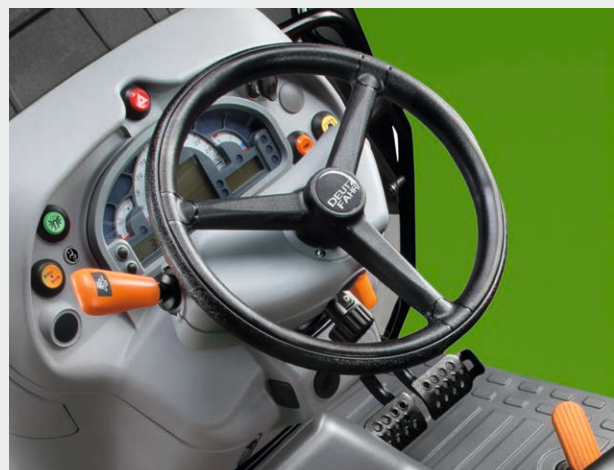
↑ Elektrohydraulisches Powershuttle-System: Fahrtrichtungswechsel, ohne zu kuppeln.
