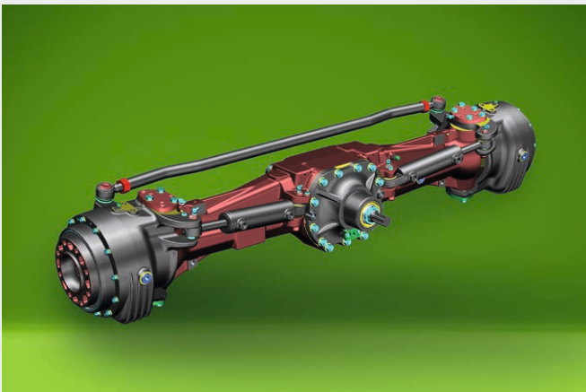
↑ Vorderachse: 50-Grad-Lenkeinschlagwinkel, elektrohydraulische Allrad- und Differenzialsperrenzuschaltung.
