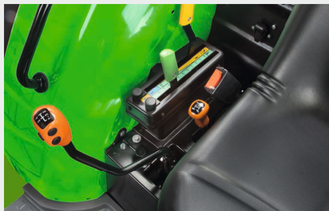
Rechts vom Fahrer: Gangschaltung, Heckkraftheber und Hydrauliksteuergeräte griffgünstig angeordnet.
