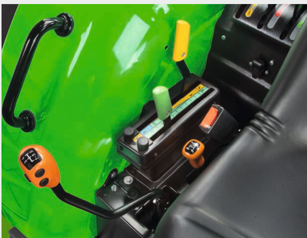
↑ Das mechanische Lastschaltgetriebe mit mechanischer Wendschaltung ist eine von zwei wählbaren Getriebeoptionen.
