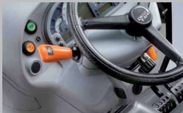
Inversor electrohidráulico: cambio del sentido de la marcha sin accionar el embrague.
