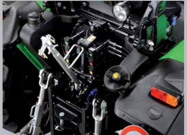
La bomba hidráulica de 55 l/min alimenta hasta tres distribuidores traseros.
