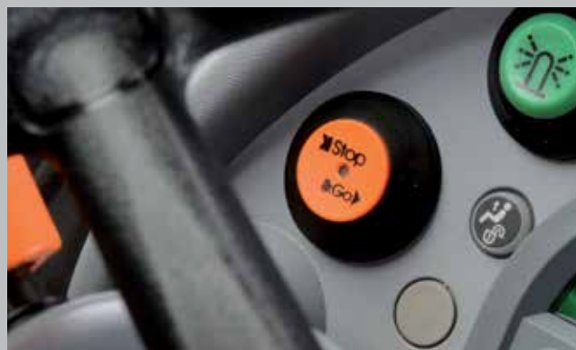
Sistema Stop&Go: permite parar y arrancar usando solo el pedal del freno.
