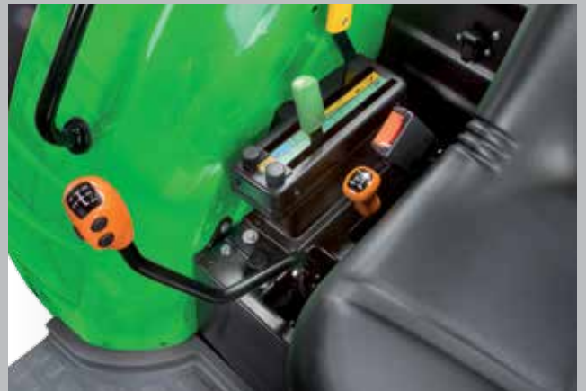
A la derecha del conductor: palanca de cambio de marchas, elevador trasero y distribuidores hidráulicos organizados ergonómicamente.
