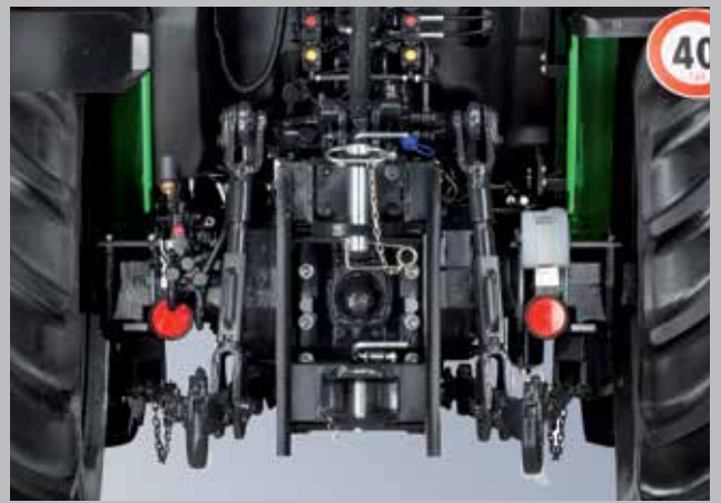
El elevador trasero: capacidad máxima de elevación de 4525 kg, control extremadamente preciso. Cuatro velocidades de TdF trasera de serie.
