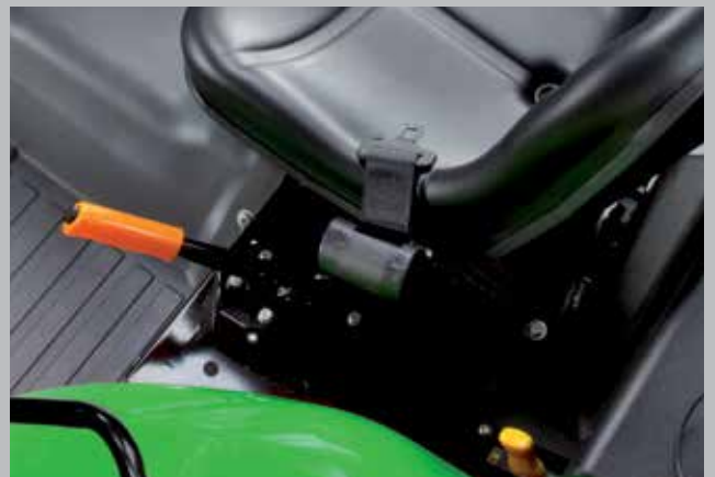
A la izquierda del conductor: mandos de TdF y freno de estacionamiento.
