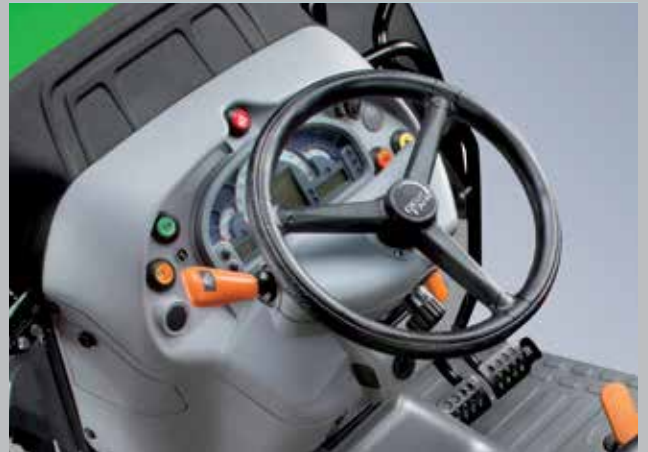
El innovador sistema de giro rápido SSD reduce a la mitad el número de vueltas de volante para cubrir el ángulo de giro completo.
