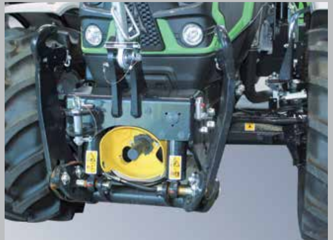
Como opción, está disponible un elevador delantero de una capacidad de 2100 kg con una toma de fuerza delantera a 1000 rpm.
