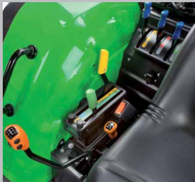
La transmisión con cambio bajo carga (Hi-Lo) con inversor electrohidráulico es uno de los dos tipos de transmisión.
