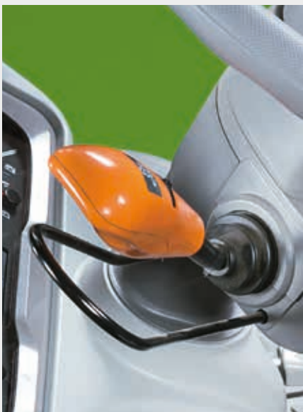
↑ Подрулевой рычаг реверса PowerShuttle с регулировкой Clutch.
