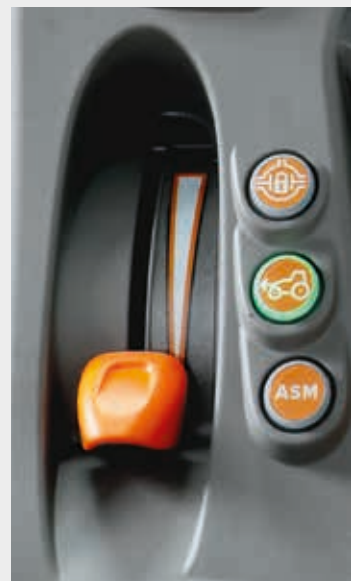
↑ Электрогидравлическое включение полпривода и блокировки дифференциала, функция ASM.
