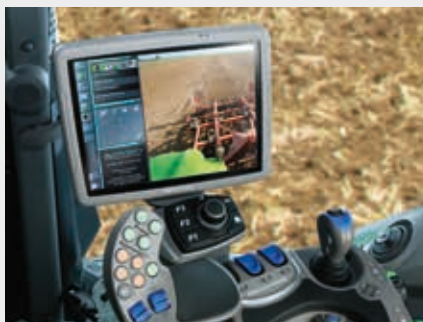
↑ Встроенная камера с автоматическим полноэкранным режимом (например, обзор при движении назад) для повышения безопасности маневров.
