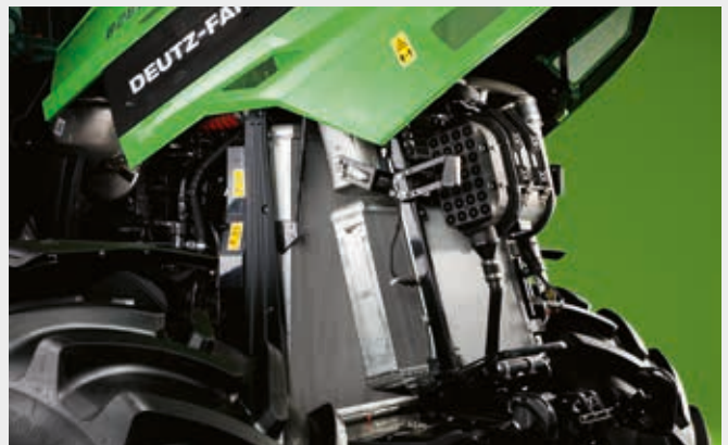
↑ Упрощенный доступ к радиатору и воздушному фильтру.
