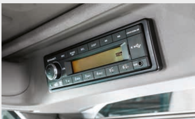
↑ Новое радио DAB+ с четырьмя динамиками и функцией громкой связи, интегрированное в InfoCentre™.
