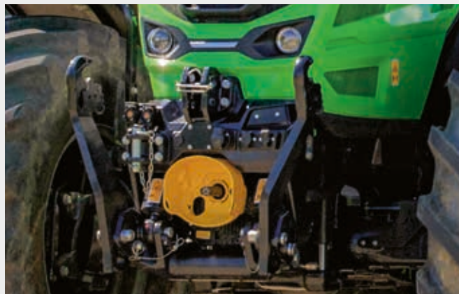
↑ ПНУ грузоподъемностью 5450 кг и двухскоростной передней ВОМ.
