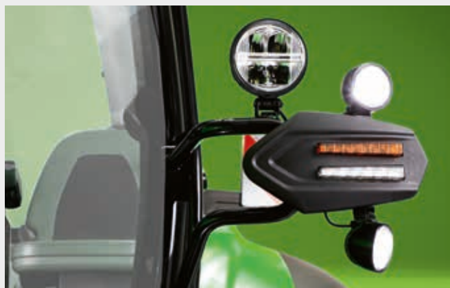
Светодиодные рабочие фары для большей площади освещения
