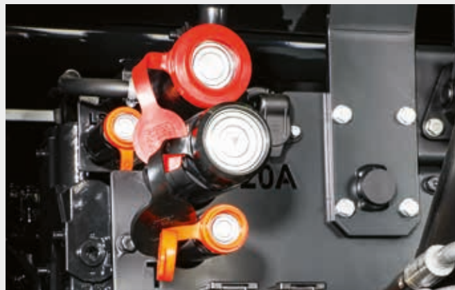
↑ Плоские гидравлические разъемы для плотного соединения.
