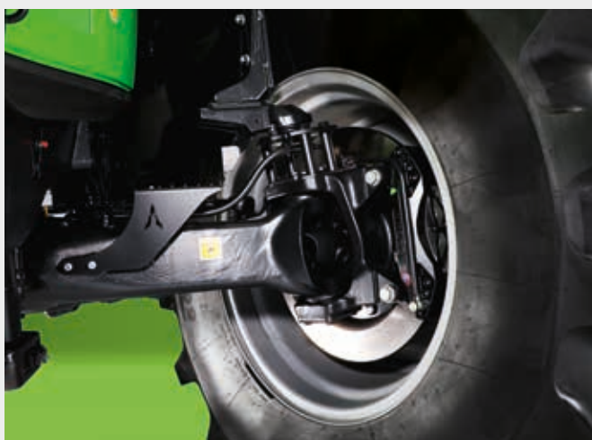
↑ Сухие дисковые тормоза для максимально эффективного торможения.
