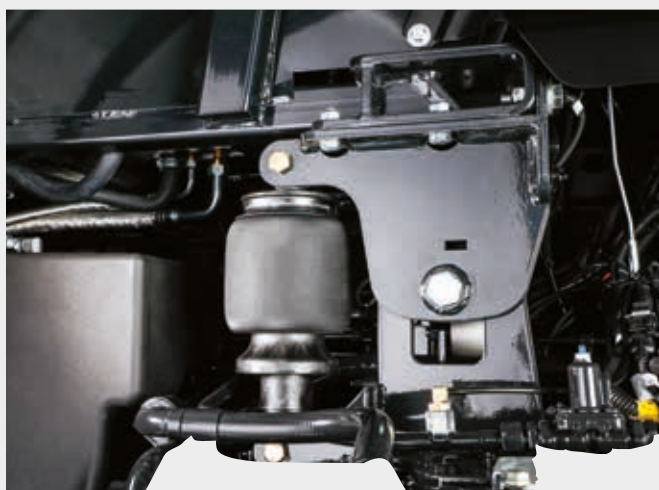
↑ Пневматическая подвеска кабины, амортизирующая удары и толчки.
