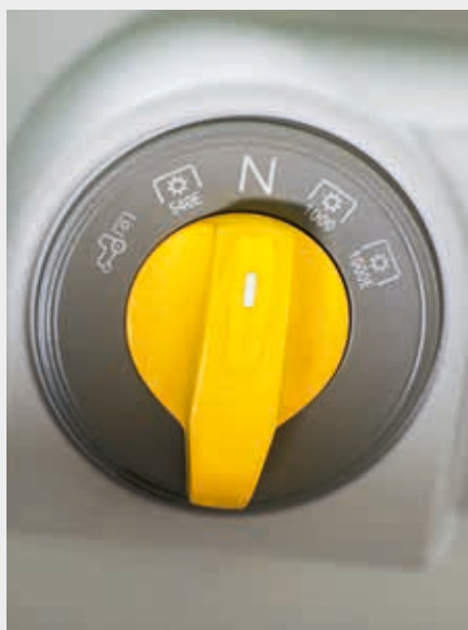
↑ Электрогидравлическое включение ВОМ.
