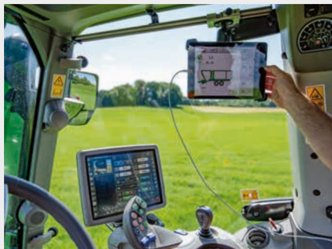
↑ Для установки дополнительных мониторов предусмотрена монтажная рейка.
