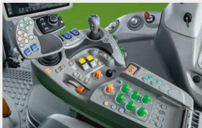
↑ Проверенная схема компоновки DEUTZ-FAHR. Для обеспечения интуитивного управления функции сгруппированы по цветам.
