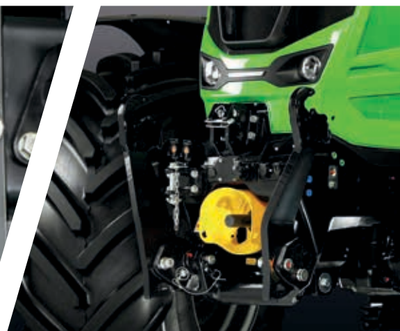
> 5450 kg hefvermogen en DualSpeed front-PTO.
