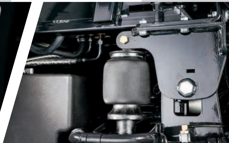
> Pneumatyczna amortyzacja kabiny zapewniająca płynną jazdę.
