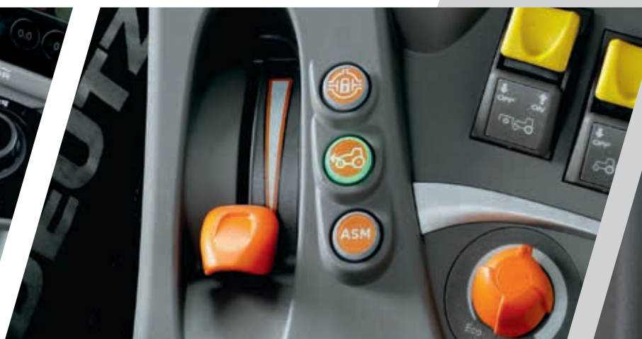
> Tração integral de controlo eletro-hidráulico e bloqueio do diferencial com botão ASM e acelerador manual independente.
