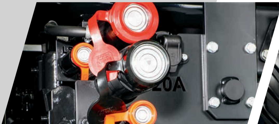
> Power Beyond com acopladores de superfície plana para uma ligação limpa.
