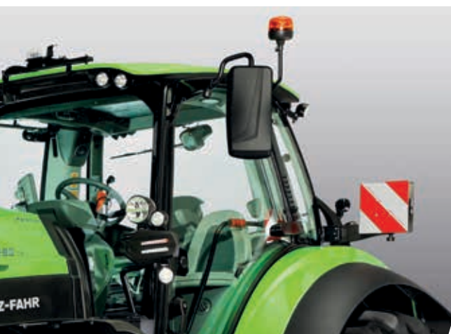
> Os novos espelhos XLargeVision, 65% maiores, e o pacote de visibilidade interna melhoram significativamente a visão de 360 graus.
