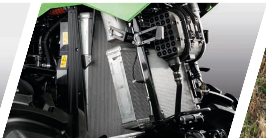
> Radiador com mecanismo de abertura simples, pré-filtro e filtro de ar PowerCore.
