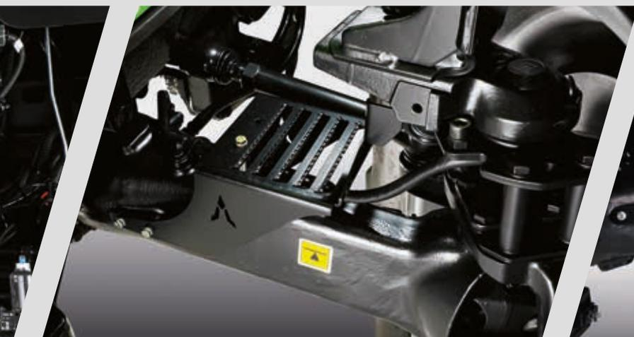
> Degraus de manutenção sobre o eixo dianteiro para uma limpeza confortável.
