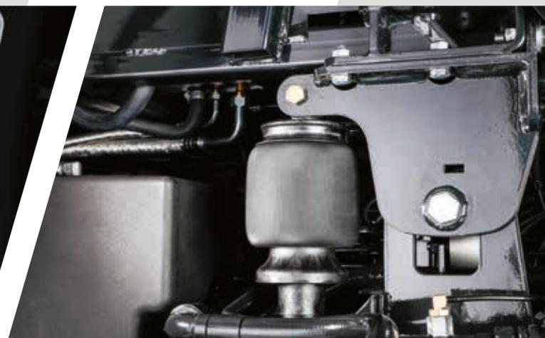
> Suspensão pneumática da cabina para uma condução suave.
