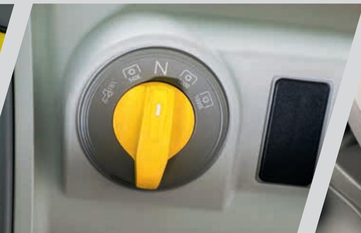
> Elektrohydraulische Zapfwellenauswahl
