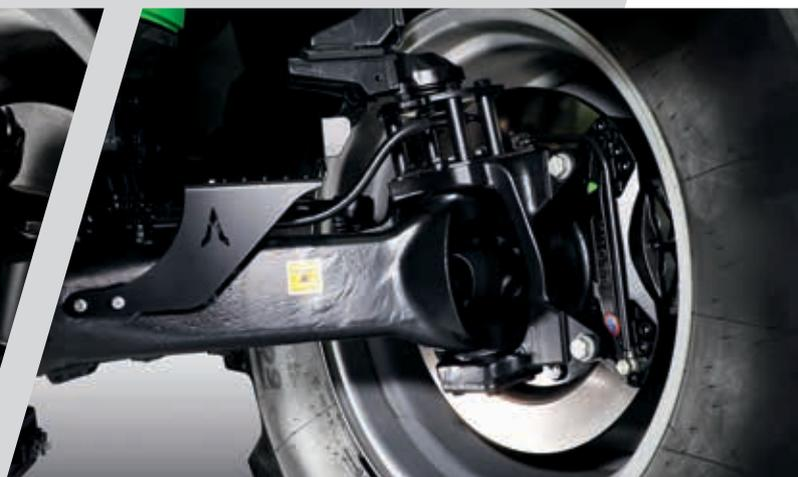
> Trockenlaufende Scheibenbremsen für maximale Bremsleistung.
