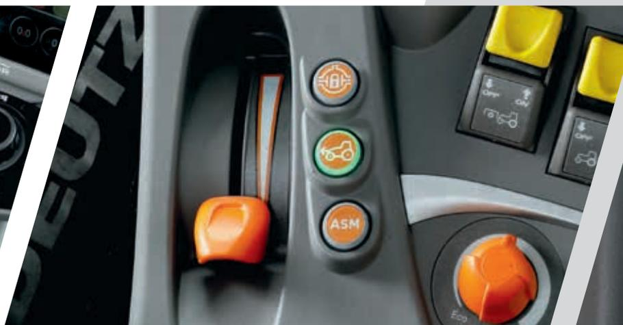
> Elektrohydraulisch betätigter Allradantrieb und Differentialsperre mit ASM-Taste und unabhängigem Handgas.
