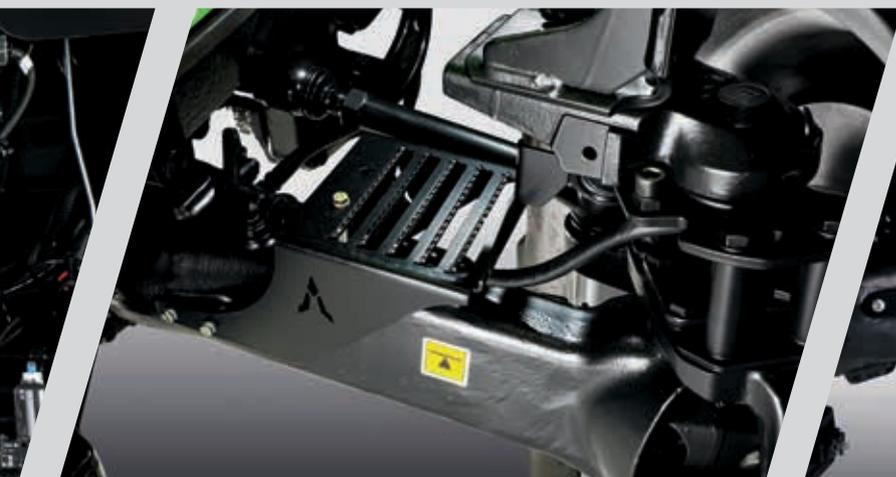
> Trittstufen auf der Vorderachse für Wartungs- und Reinigungsarbeiten.
