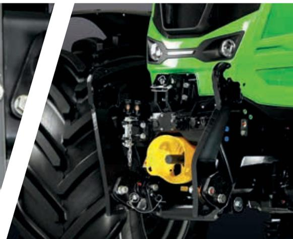
> 5450 kg Hubkraft und DualSpeed-Frontzapfwelle.
