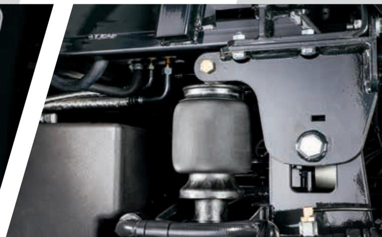
> Druckluftgefederte Kabine für hohen Fahrkomfort.
