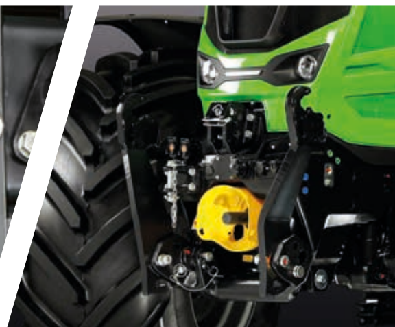
> 5450 kg Hubkraft und DualSpeed-Frontzapfwelle.
