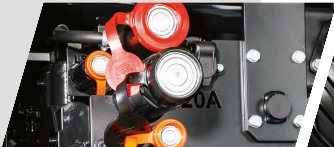
> Power Beyond mit Flachkupplungen für einen sauberen Anschluss.
