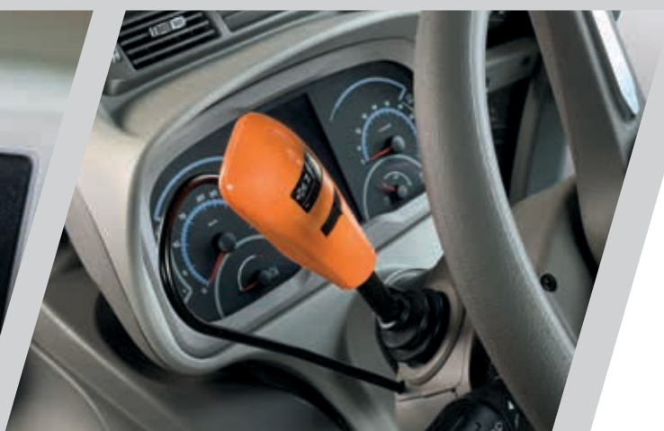
> Inversor electrohidráulico con SenseClutch.
