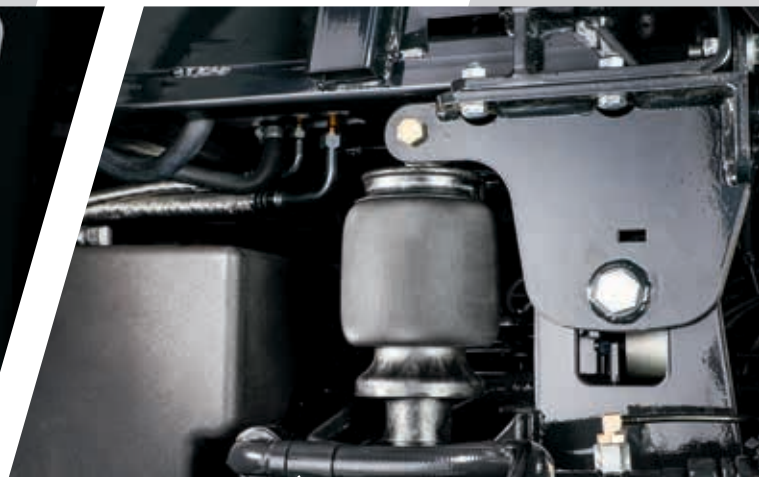
> Suspensión neumática de la cabina para mayor suavidad de marcha.
