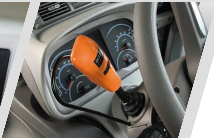
> Inverseur électrohydraulique PowerShuttle avec SenseClutch.
