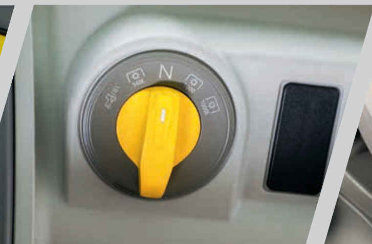
> Selezione elettroidraulica della PTO.
