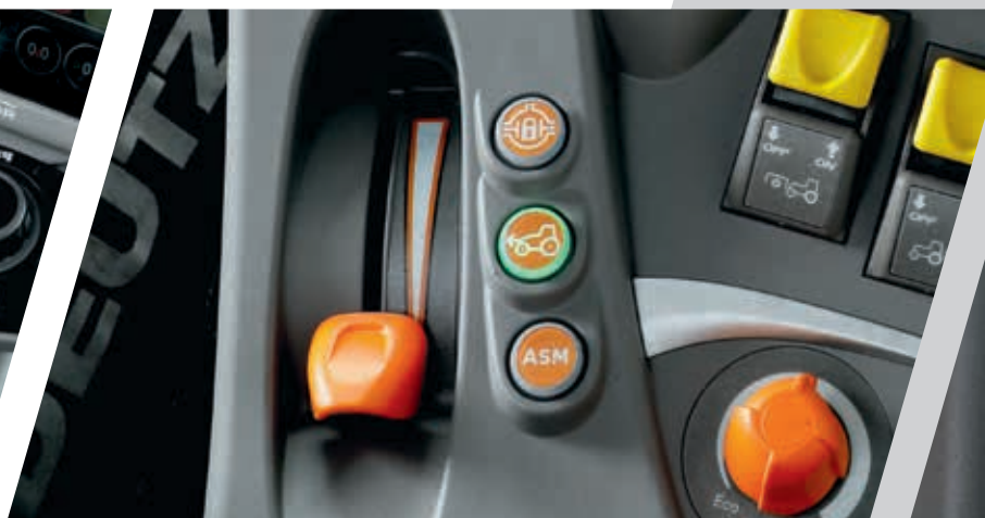
> Trazione integrale e bloccaggio del differenziale a comando elettroidraulico con pulsante ASM e acceleratore a mano indipendente.
