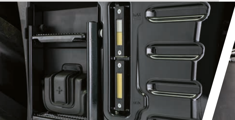
> Porta di collegamento per avviamento di emergenza e vetro spia di livello olio.
