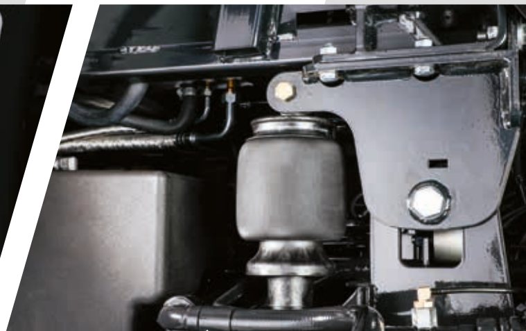
> Sospensione pneumatica della cabina per una guida più regolare.
