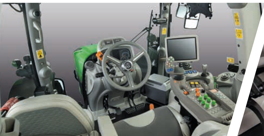
> Interni della cabina MaxiVision Pro .
