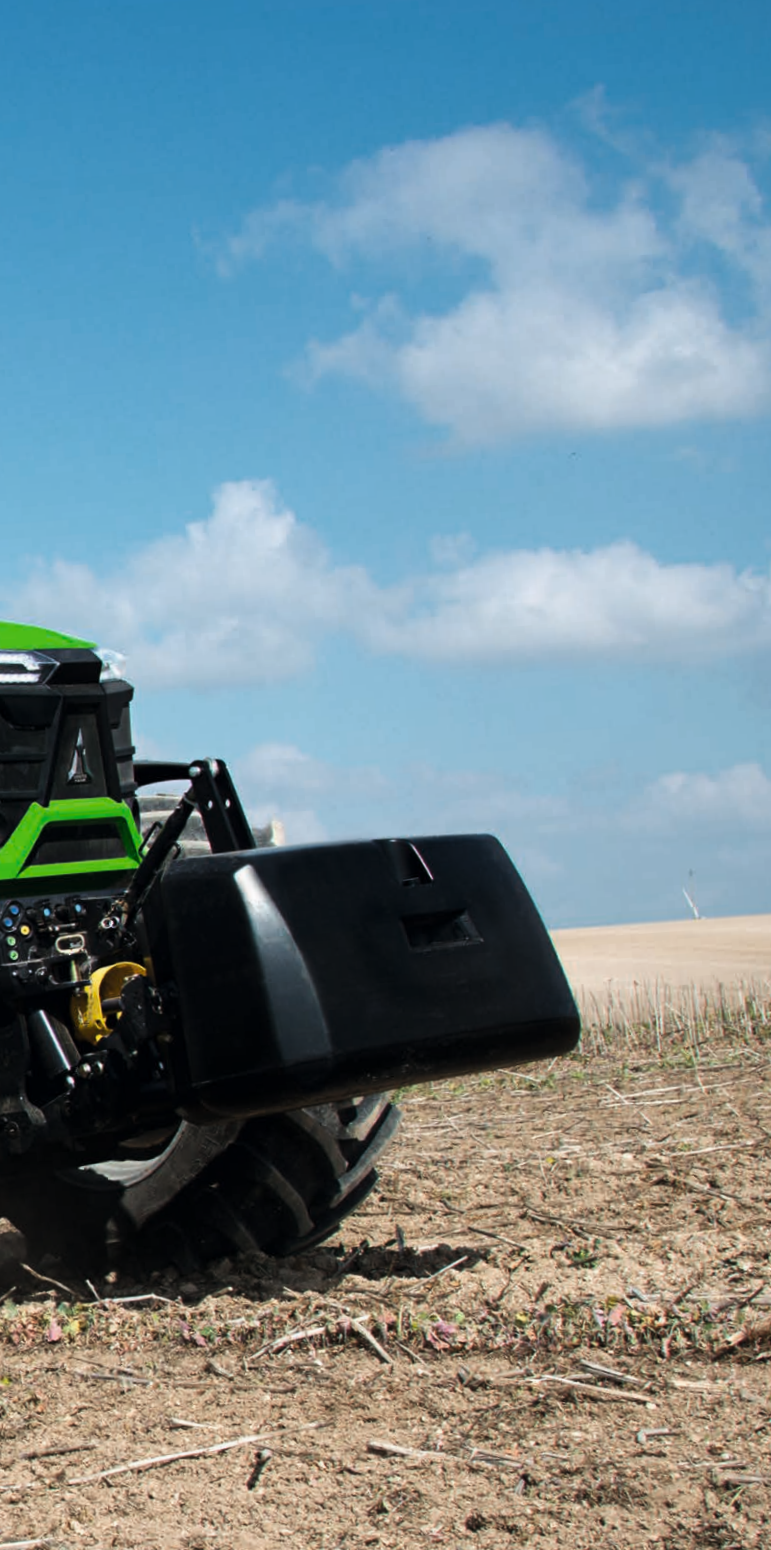
↑ Vooras: Maximaal veringseffect en een stuurhoek tot 50° zorgen voor een optimale wendbaarheid.
