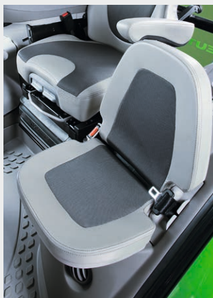
↑ Verstelbare, gedeeltelijk met leer beklede bestuurdersstoel met instelbare veringsmogelijkheden en een gevoerde passagiersstoel.
