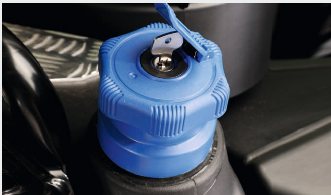
↑ Afsluitbare tankdop voor brandstof- en AdBlue-tanks.
