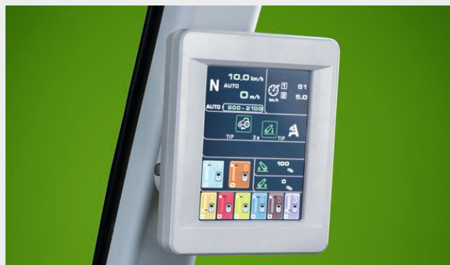
↑ Er kunnen drie rij-/werkstrategieën worden geselecteerd: manueel, automatisch en PTO. Deze worden op de WorkMonitor weergegeven.
