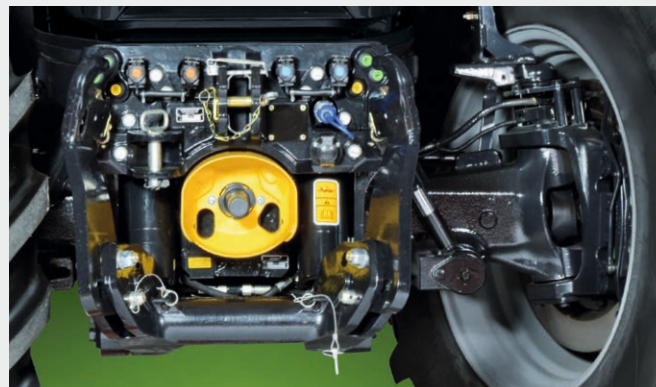
↑ Vooras: Maximaal veringseffect en een stuurhoek tot 50° zorgen voor een optimale wendbaarheid.
