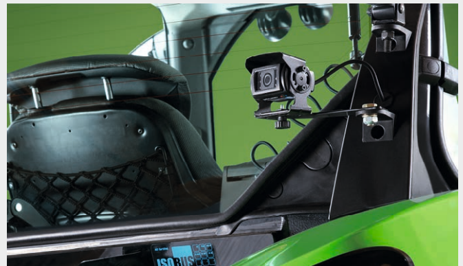
↑ Geïntegreerde camera met automatische fullscreen-modus (bijv. bij het achteruitrijden) voor overzicht en veiligheid.
