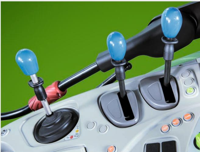
↑ Mechanische oder elektrohydraulische Steuergeräte. Sie haben die Wahl.
