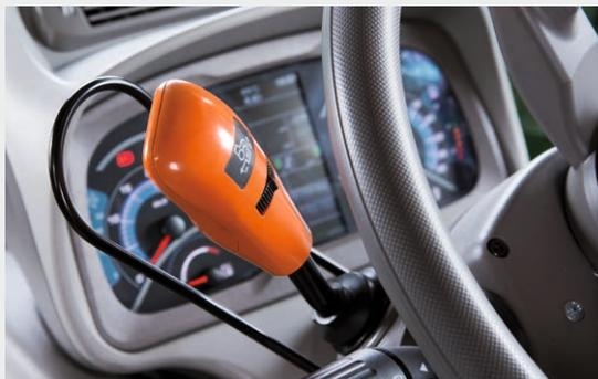
↑ Powershuttle mit fünfstufig vorwählbarem Ansprechverhalten für den Fahrtrichtungswechsel ohne Drehmomentunterbrechung.
