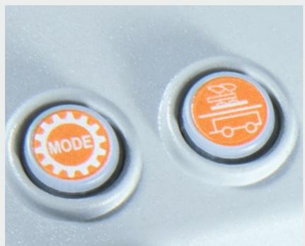
↑ Zwei Arbeitsbereiche, Feld und Transport, elektrohydraulisch schaltbar.
