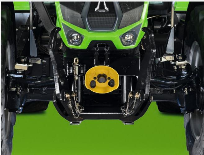
↑ Leistungsstarker Frontkraftheber mit bis zu 2.880 kg Hubkraft. Comfortpaket mit einem Zusatzsteuerventil in der Front verfügbar.
