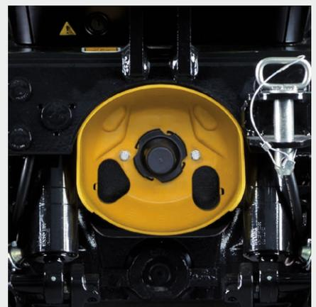
↑ Für noch mehr Einsatzvielfalt ist optional eine Frontzapfwelle wählbar.
