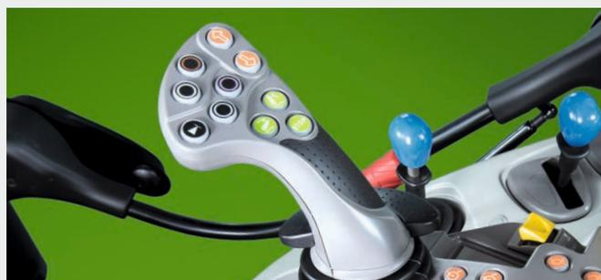
↑ Die Bedienung der TTV-Modelle erfolgt über den neuen MaxCom Joystick. Vier Knöpfe sind frei belegbar.
