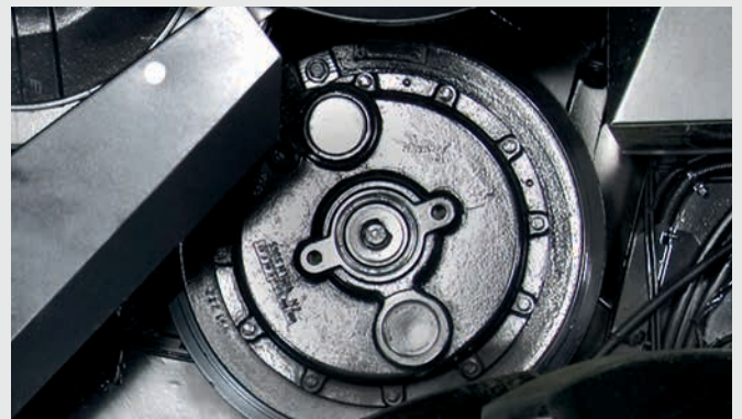
↑ Optionele snelheidsreductie-eenheid voor dorstrommel, voor het instellen van de snelheid van de dorstrommel tussen 1250 tot 625 omw./min. als maximumsnelheid en 420 tot 210 omw./min. als minimumsnelheid.. Deze kit wordt aanbevolen voor het oogsten van maïs.
