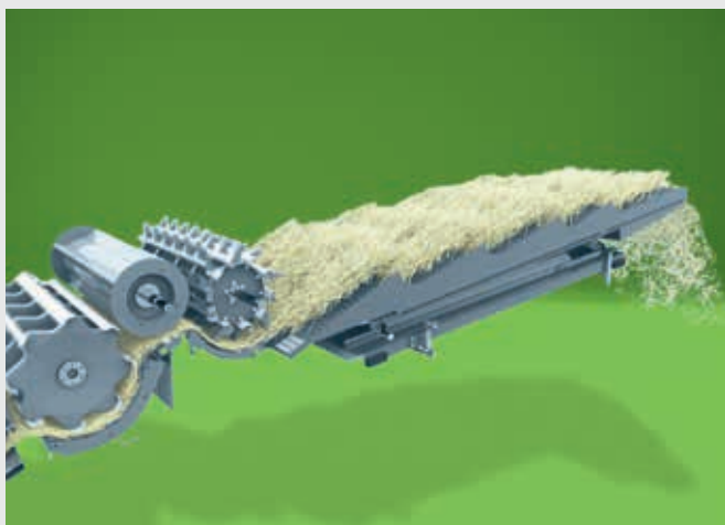
↑ Lange stroschudders met open bodem en een totaal schudoppervlak van 6,92 m 2 voor C9306-modellen en 5,80 m 2 voor C9305-modellen, kunnen een grote hoeveelheid stro verwerken.
