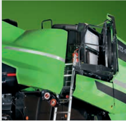
↑ Volledige toegang tot de radiatoren: brede openingshoek en speciaal platform.
