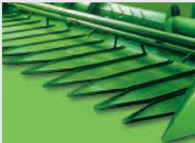
↑ Voor het oogsten van zonnebloemen is een speciale kit ontworpen die op DEUTZ-FAHR-standaardmaaiborden tot een breedte van 7,2 m kan worden gemonteerd.
