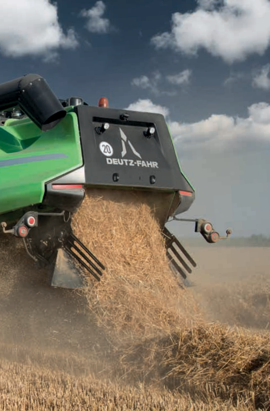
↑ Grote strokap losgoot om de productstroom van het lange stro te maximaliseren.
