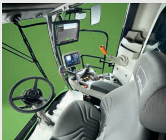
↑ Tweede iMonitor voor Agrosky, opbrengstbewaking en cameraweergaven.
