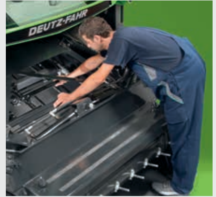
↑ Gemakkelijke toegang voor het afstellen en controleren van de kettingen op het toevoer kanaal.
