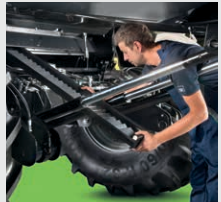
↑ De segmenten van de voorbereidingsbodem zijn eenvoudig uit de steenvanger te verwijderen.
