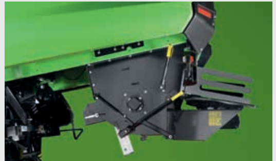
↑ Grote strokap losgoot om de productstroom van het lange stro te maximaliseren.
