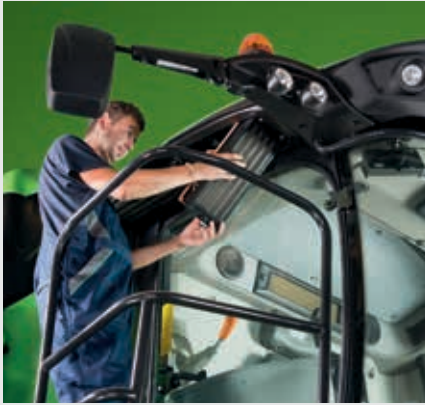
↑ Demontage van de luchtfilters van de cabine zonder gereedschap.
