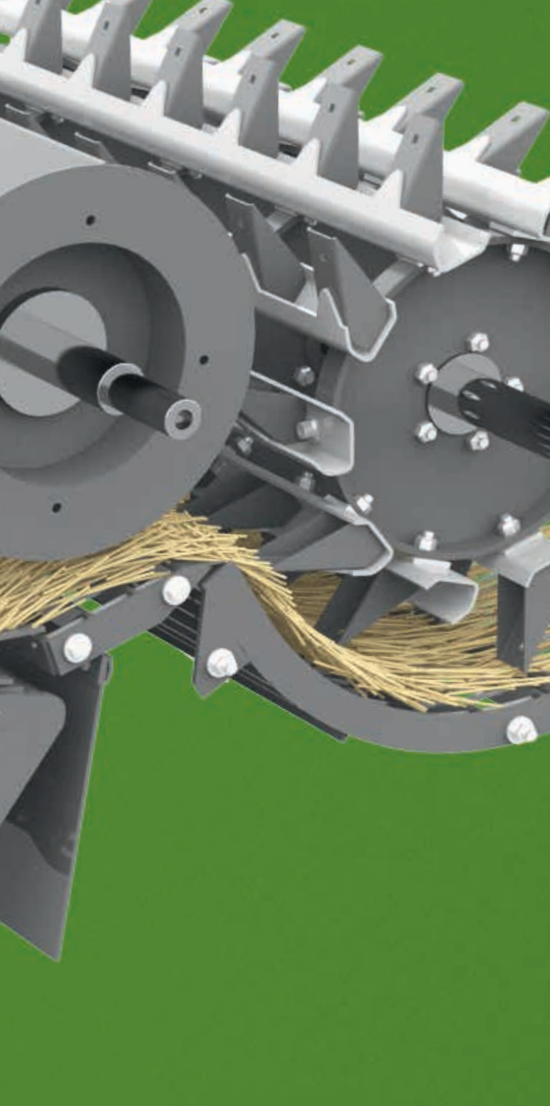
De afstand tussen de dorskorf en -trommel kan onafhankelijk van elkaar aan de voor- en achterzijde worden ingesteld via elektrische actuatoren, die worden aangestuurd door de Commander Control.
