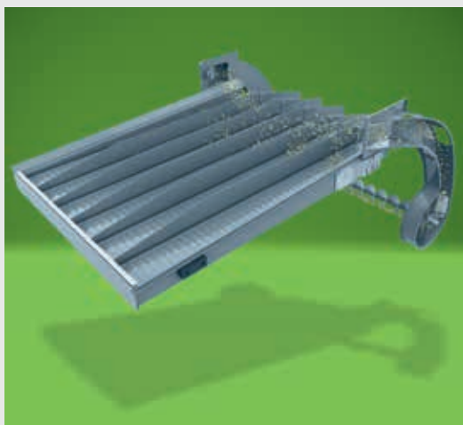
↑ DGR-systeem: retourlevator aan weerszijden van de machine met speciale frictieplaten om het gewas te dorsen en het terug te leiden naar de voorbereidingsbodem.
