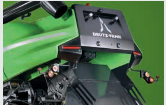
↑ Grote strokap losgoot om de productstroom van het lange stro te maximaliseren.
