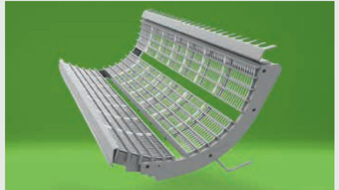
↑ Gesegmenteerde dorskorf voor eenvoudige aanpassing van de maaidorser aan verschillende gewassen of oogstomstandigheden, met een mogelijke afstand tussen de draden van 11 mm tot 20 mm.
