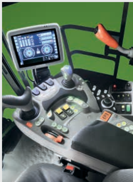
↑ Bedieningselementen met achtergrondverlichting voor een uitstekende zichtbaarheid en toegankelijkheid.
