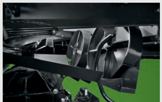
↑ De spreading van het gehakselde stro over de gehele breedte van het maaibord, onder alle omstandigheden. Geïntegreerde kafspreader voor een gelijkmatige voorbereiding van de bodem.
