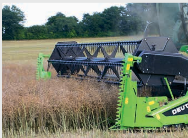
↑ Voor het oogsten van koolzaad werd een speciale kit ontworpen die op DEUTZ-FAHR-standaardmaaiborden tot 7,2 m kan worden gemonteerd.
