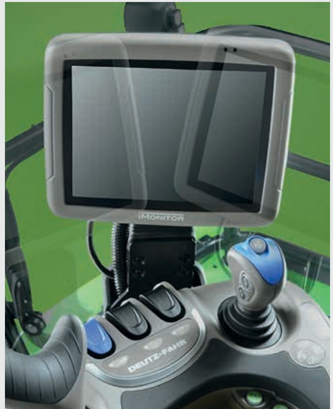
↑ Eenvoudige aanpassing van de positie van het touchscreen.
