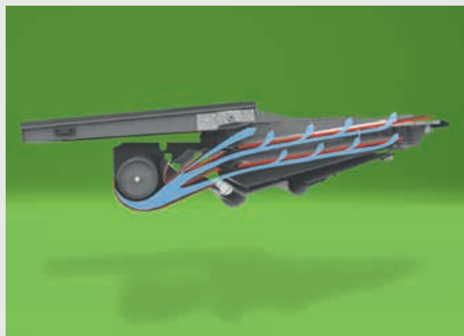
↑ De krachtige turbinebeluchting bereikt het gehele schonings- en scheidingsoppervlak.
