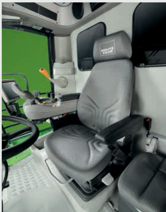
↑ Extra grote stoel met geïntegreerde multifunctionele armleuning voor topcomfort en bedieningselementen.
