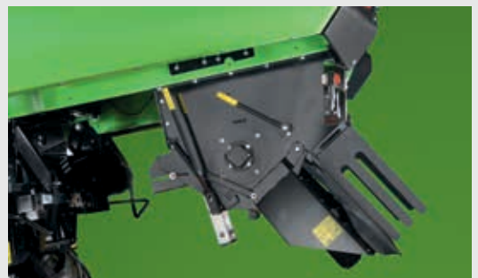
↑ Strohakseleenheid met spreider, verstelbaar in 3 posities. De spreidereenheid wordt terwijl hij niet in gebruik is, omgevormd tot een goot voor het lange stro.
