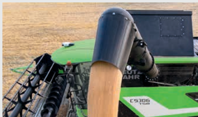
↑ Geïntegreerde verlichting en camera op de losbuis om de loswerkzaamheden te controleren.
