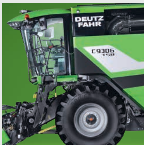
⬆ Eenvoudige toegang tot de cabine dankzij de nieuwe ladder met automatisch in- en uitklapsysteem.
