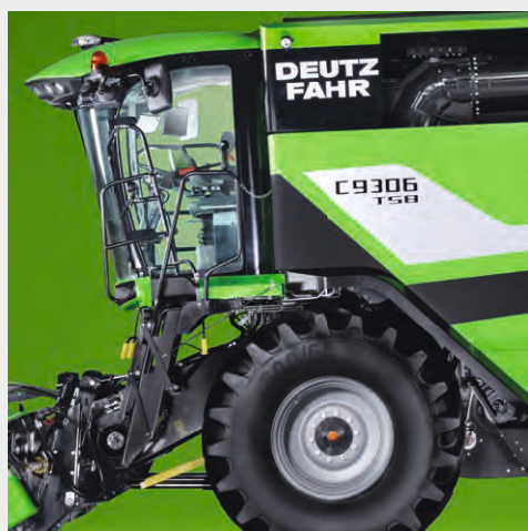
↑ Bequemer Zustieg zur Kabine dank der neuen Leiter, die sich automatisch ein- und ausfahren lässt und drehbar gelagert ist.
