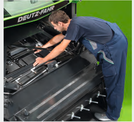
↑ Müheloser Zugang zur Kontrolle der Einzugsketten durch eine große Wartungsöffnung.
