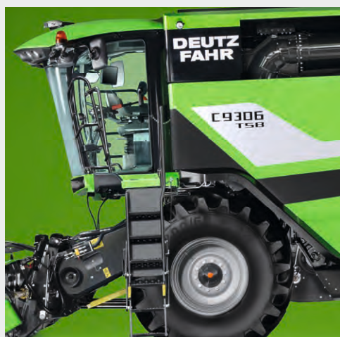
↑ Bequemer Zustieg zur Kabine dank der neuen Leiter, die sich automatisch ein- und ausfahren lässt und drehbar gelagert ist.
