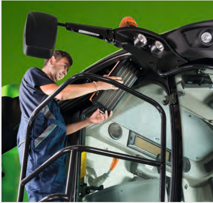
↑ Die Luftfilter aussen im Kabinendach lassen sich werkzeuglos ein- und ausbauen.
