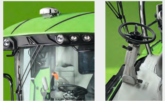
Problemlose Installation der Präzisionserntesysteme, vollständige Integration des elektrisch unterstützten Lenksystems, der GPS-Antenne, der Ertragsensoren und der Isobus-ECU.
