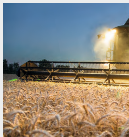
⬆ Bis zu 10 Arbeitsscheinwerfer an der Kabine, am bei Nachtarbeit.
