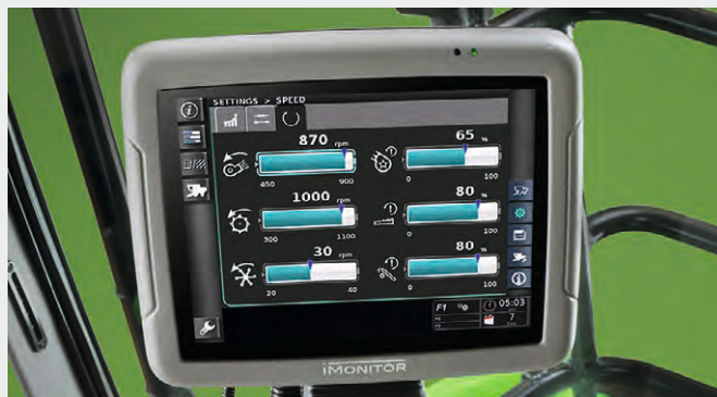
↑ Alle Parameter und Funktionen des Mähdreschers lassen sich direkt am iMonitor verwalten.
