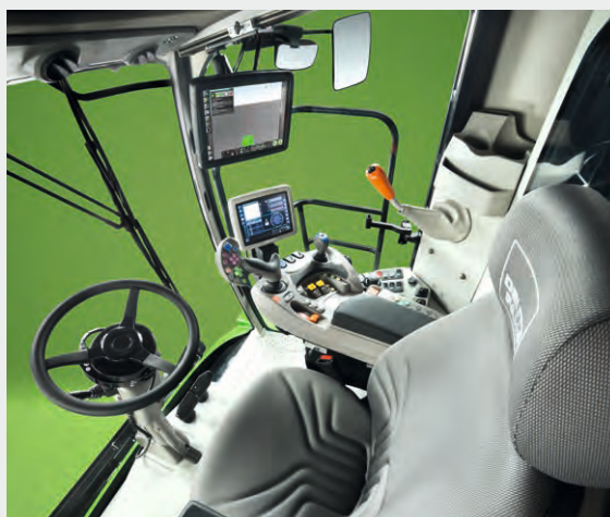
↑ Zweiter iMonitor bei Agrosky, Ertrags- und Kameraüberwachung.
