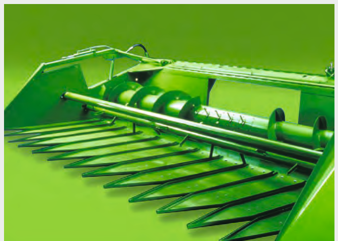
↑ Zur Sonnenblumenernte ist ein Zubehörsatz erhältlich, der zusammen mit Schneidwerken von DEUTZ-FAHR bis zu einer Breite von 7,20 m eingesetzt werden kann.
