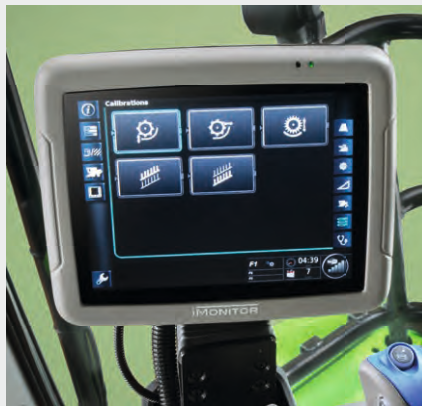
↑ Durchführung und Überprüfung der Kalibrierung aller wichtigen Systeme direkt über den iMonitor.
