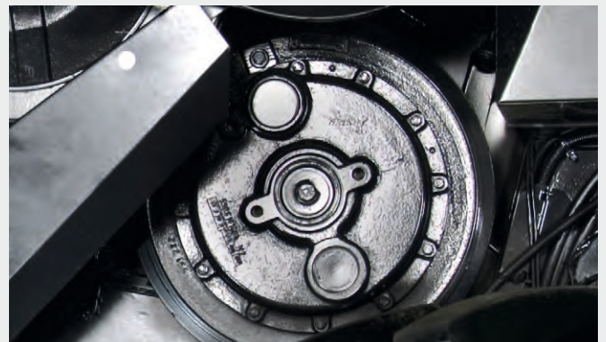
⬆ Optional erhältliches Reduziergetriebe für die Dreschtrommel, um die Höchstdrehzahl von 1.250 auf 625 U/min und die Mindestdrehzahl von 420 auf 210 U/min herabzusetzen. Dieses Zubehör wird zum Maisdrusch empfohlen.
