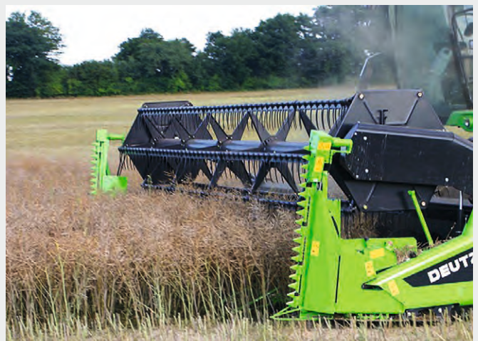
↑ Für den Rapsdrusch steht ein spezieller Rapsvorsatz zur Verfügung, der mit den Schneidwerken von DEUTZ-FAHR bis zu einer Breite von 7,20 m kompatibel ist.
