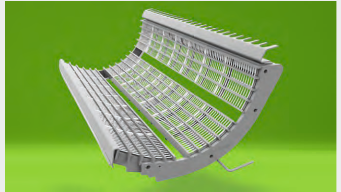
⬆ Segmentdreschkorb zur einfachen Anpassung des Mähdreschers an unterschiedliche Fruchtarten und Druschverhältnisse, wobei unterschiedliche Drahtabstände für den Dreschkorb von 11 mm bis 20 mm verfügbar sind.
