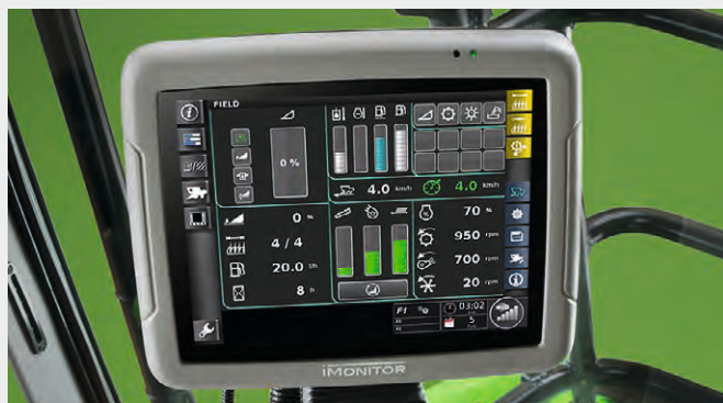
↑ Spezielle Ansicht für die Arbeit auf dem Feld mit allen erforderlichen Informationen für die Erntearbeit, benutzerspezifisch konfigurierbar.
