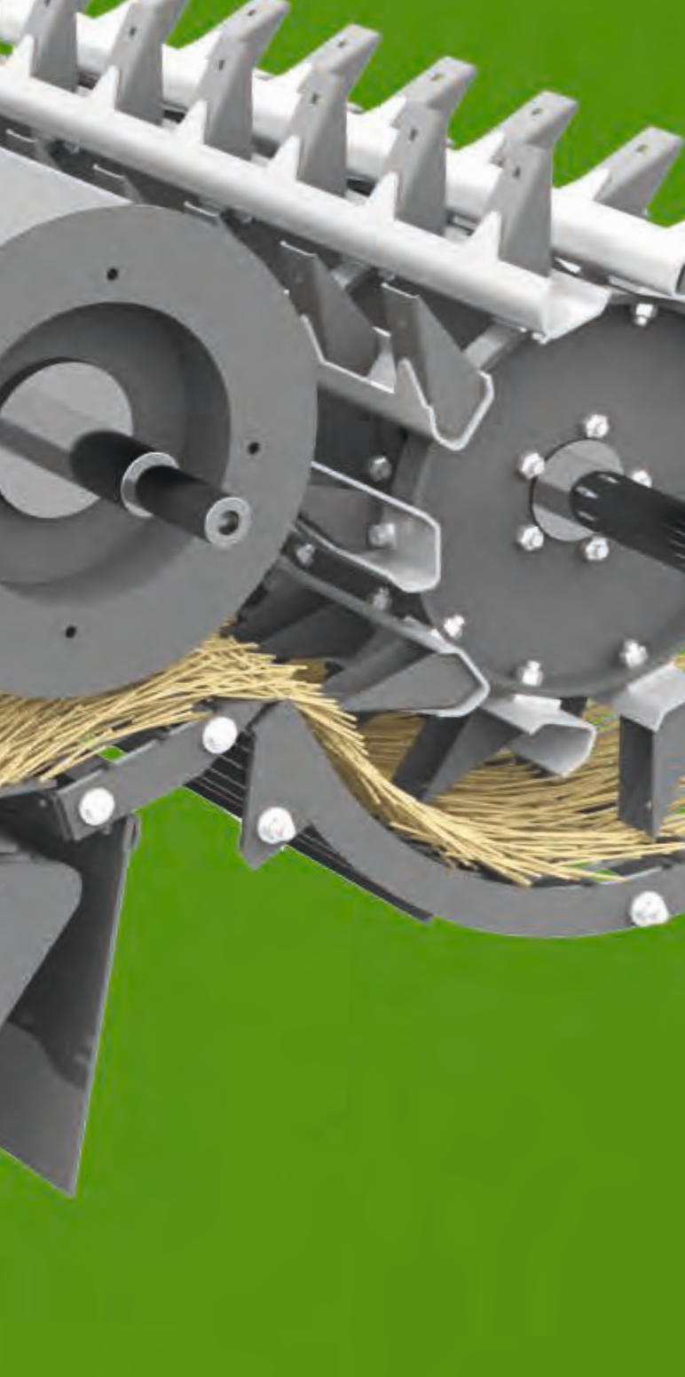
Die Abstände zwischen Dreschkorb und Dreschtrommel sind unabhängig voneinander vorn und hinten über elektrische Stellmotoren einstellbar, die von der Kabine aus über den iMonitor gesteuert werden.
