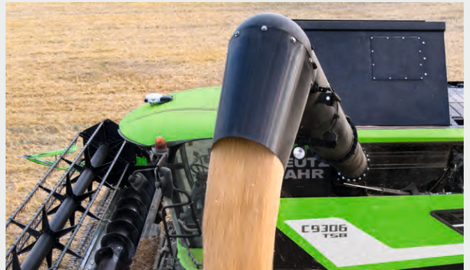
↑ Beleuchtung und Kamera am Korntankrohr zur Kontrolle des Entleerungsvorgangs.
