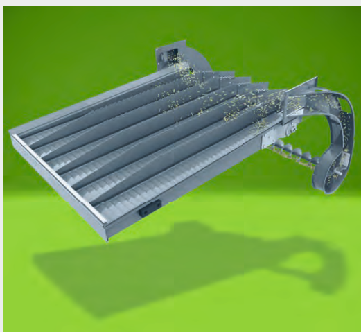
↑ Beidseitige Überkehrrückführung: Wurfelevatoren zur Überkehrrückführung auf beiden Seiten der Maschine mit speziellen Reibeinsätzen, mit denen das Erntegut auf dem Weg zurück zum Vorbereitungsboden nochmals gedroschen wird.
