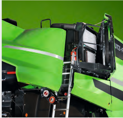
↑ Ungehindert Zugang zu den Kühlern: breiter Aufstieg und eine komfortable Wartungsplattform.
