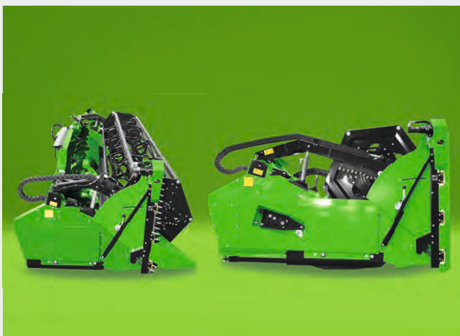
↑ Der untere Teil kann hydraulisch um bis zu 700 mm ausgefahren werden. Die vertikal angeordneten Seitenmesser werden hydraulisch betätigt und können zurück geklappt werden, um ein Umrüsten des Schneidwerkes für die Rapsernte zu vereinfachen.
