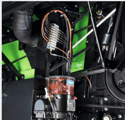
↑ Zentral zusammengefasste Schmierstellen (links). Automatschmierung (rechts).
