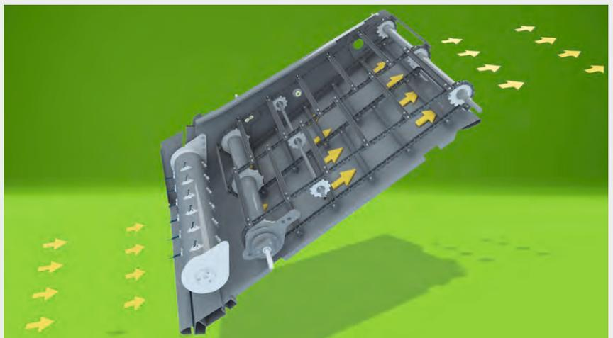
⬆ Les barrettes alternées du convoyeur distribuent uniformément et rapidement le produit. La longueur des doigts peut être facilement ajustée dans 3 positions différentes pour s'adapter à tous les types de cultures.
