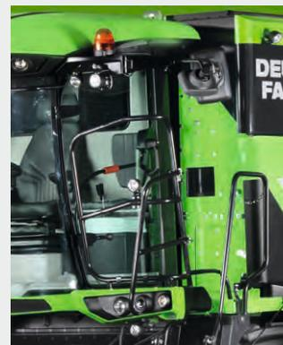
↑ Double fenêtre de contrôle dans la cabine, trappe de prélèvement d'échantillons facile d'accès à l'extérieur de la cabine.
