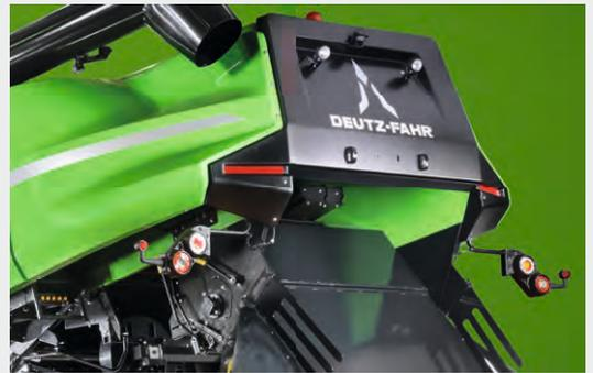
↑ Grande goulotte d'évacuation du capot pour maximiser l'écoulement du produit de la paille longue.
