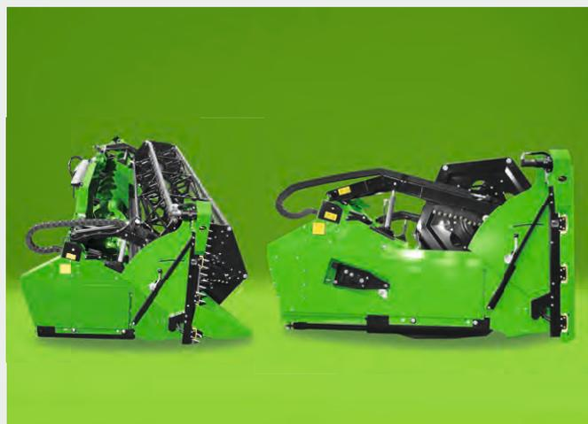
↑ Le tablier peut être étendu hydrauliquement jusqu'à 700 mm. Les scies verticales sont entraînées hydrauliquement et repliables, ce qui réduit l'opération de conversion de la barre de coupe pour la récolte du colza.
