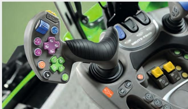
↑ Contrôle en douceur de la transmission avec le COMMANDER STICK électronique. La direction est sélectionnée par la combinaison du bouton d'autorisation et du déplacement du levier dans la direction souhaitée. Plus le mouvement est grand, plus la vitesse est rapide. Le régulateur de vitesse maintient la vitesse de travail optimale, tandis que de petits réglages peuvent être effectués en poussant ou en tirant vers l'arrière le COMMANDER STICK pour augmenter ou réduire la vitesse respectivement.
