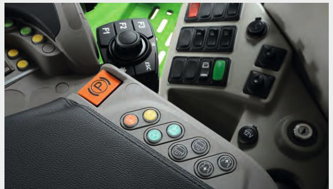
↑ À l'arrière de l'accoudoir se trouvent les commandes des 4 roues motrices, du frein de stationnement, de l'ouverture de la trémie à grains, du MMI et du nouveau tableau de bord avec prises USB.
