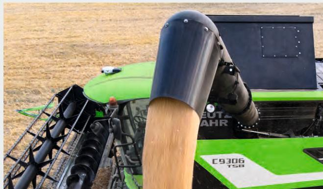
↑ Lumière et caméra intégrées sur le tuyau de déchargement pour contrôler les opérations de déchargement.
