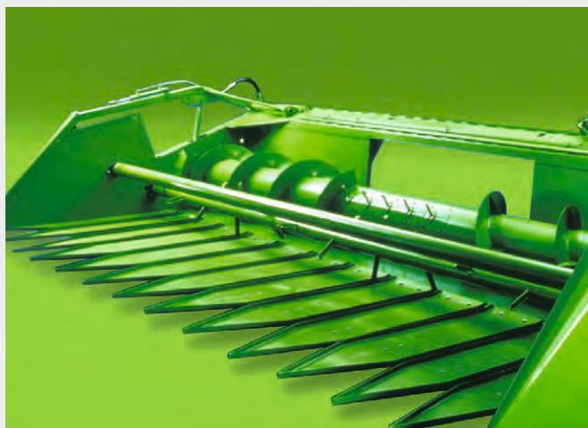
↑ Pour la moisson du tournesol, un kit a été conçu et peut être monté sur toutes les barres de coupe DEUTZ-FAHR jusqu'à 7,20 m de large.
