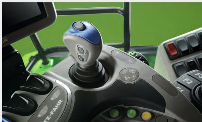
↑ Joystick simple et intuitif pour contrôler le système BALANCE. Fonction automatique et manuelle, position neutre et fonction route. Position ergonomique et confortable intégrée dans l'accoudoir de commande.
