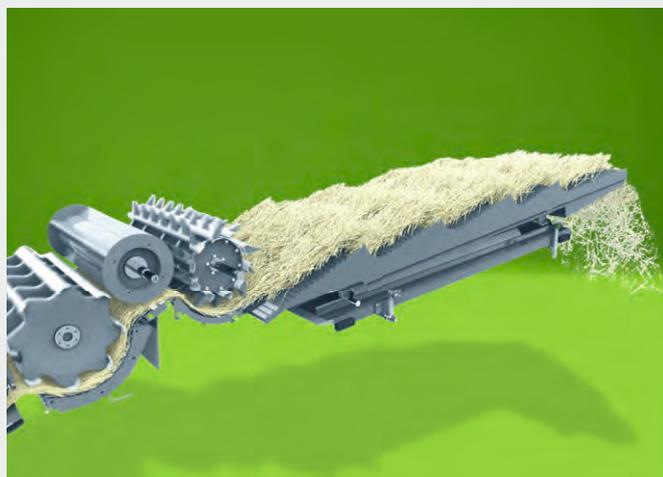
↑ Les secoueurs longs à fond ouvert, avec une surface de secouage totale de 6,92 m<sup>2</sup> pour les modèles C9306, gèrent d'énormes quantités de paille.
