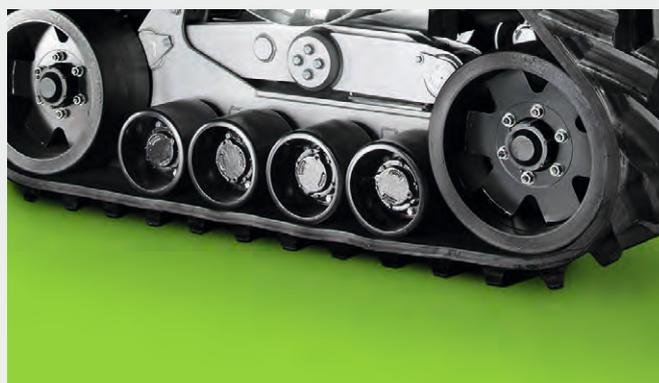
↑ Les chenilles en caoutchouc H.D. avec transmission finale intégrée permettent à la moissonneuse-batteuse pour garder la largeur hors tout en dessous de 3,5 m. Le compactage est au niveau le plus bas tandis que la traction est à son maximum.
