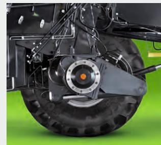
↑ Les réducteurs d'une capacité de 25 t permettent à la machine de travailler dans les conditions les plus extrêmes, tout en continuant à offrir une fiabilité maximale et, surtout, la sécurité du conducteur.
