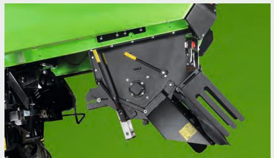
↑ Broyeur de paille avec déflecteur réglable en 3 positions. Ceci permet de s'adapter au grande largeur de barre de coupe Deutz-Fahr
