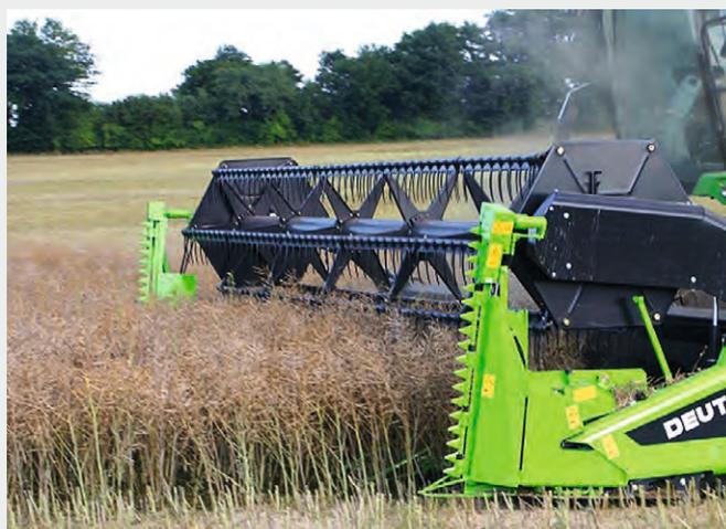
↑ Un kit spécialement conçu pour le colza a été mis au point, qui s'applique à toutes les barres de coupe DEUTZ-FAHR standard jusqu'à 7,2 m.
