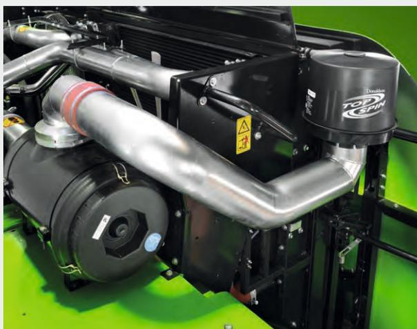
↑ Filtre à air du moteur à pré-nettoyage avec système d'auto-nettoyage automatique.
