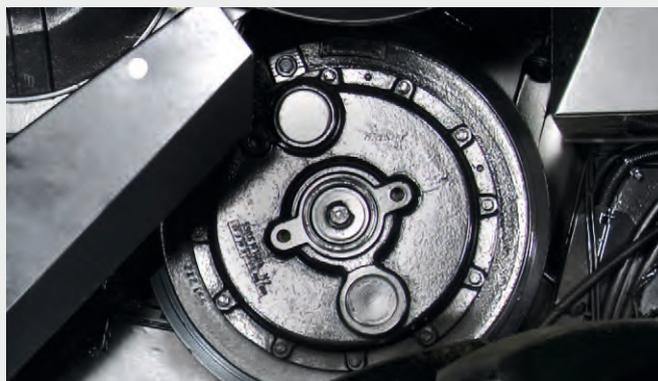
↗ Réducteur de vitesse du batteur en option pour régler la vitesse de rotation du batteur de 1250 à 625 comme vitesse maximale et de 420 à 210 tr/min comme vitesse minimale. Ce kit est conseillé lors de la récolte du maïs.
