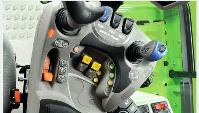
↑ Sélection facile des systèmes de moissonneuse-batteuse - contre-batteuse (avant et arrière), grilles (supérieur ou inférieur) et séparateur Turbo - avec réglage facile par 3 touches tactiles. Commandes de la barre de coupe pour le réglage du mode, de la hauteur et de la pression du sol. La commande par joystick du système BALANCE permet un réglage intuitif et précis.
