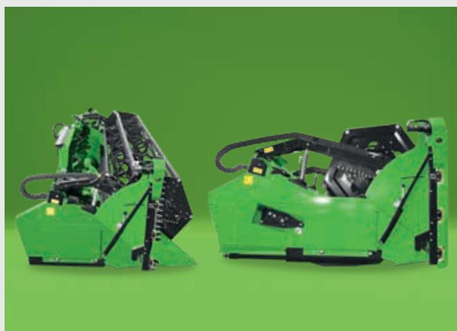
↑ Il pianale inferiore si allunga idraulicamente fino a 700 mm.
