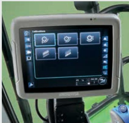
↑ Esecuzione e controllo della calibrazione di tutti i principali sistemi direttamente dall'iMonitor.
