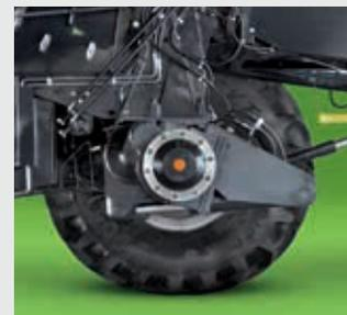
↑ Gli assali da 25 t di capacità permettono di lavorare nelle condizioni più estreme, garantendo la massima affidabilità e soprattutto la sicurezza per l'operatore.
