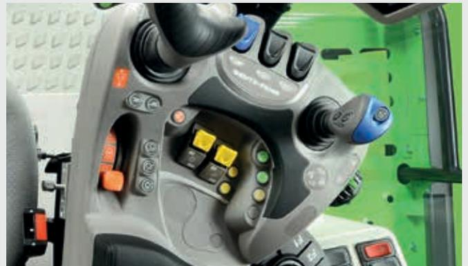
↑ Facile selezione dei sistemi della mietitrebbia - controbattitore (anteriore e posteriore), crivelli (superiore o inferiore) e turboseparatore con facile regolazione mediante 3 pulsanti a sfioramento. Comandi piattaforma di taglio per regolazione modalità, altezza e pressione al suolo. Il comando a joystick per il sistema BALANCE assicura una regolazione intuitiva e precisa.
