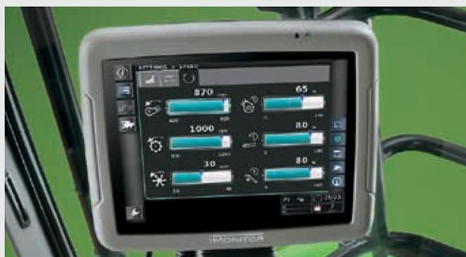
↑ Tutti i parametri e le funzioni della mietitrebbia vengono gestiti direttamente sull'iMonitor.
