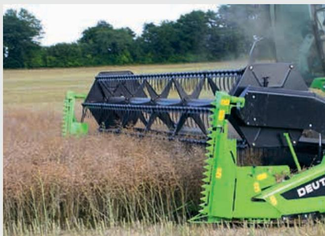
↑ Per la raccolta della colza esiste un kit appositamente progettato e applicabile a tutte le piattaforme di taglio DEUTZ-FAHR standard fino a 7,2 m.
