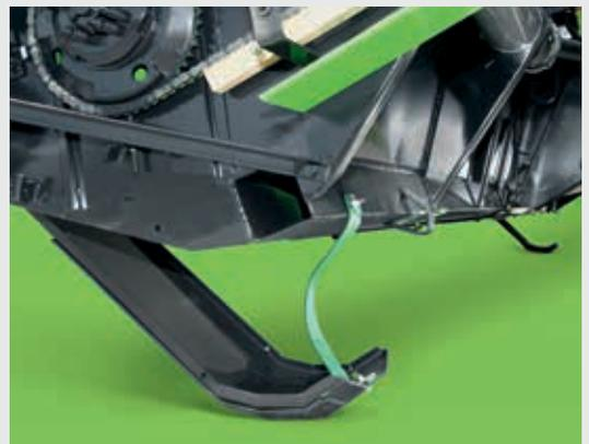
↑ Robuste slitte tastatrici integrano i sensori del terreno per controllare la posizione della piattaforma di taglio anche su terreni irregolari.
