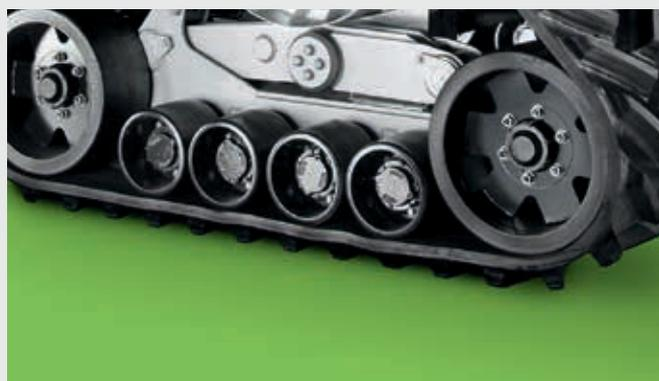
Cingoli Heavy duty in gomma con riduttori laterali integrati consentono di mantenere la larghezza complessiva della mietitrebbia al di sotto di 3,5 metri. La compattazione è minima e la trazione massima.
