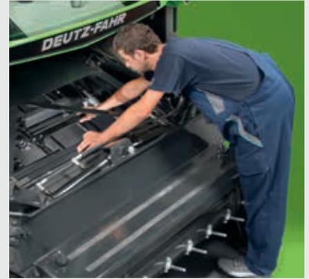
↑ Agevole accesso per la regolazione e il controllo delle catene sul canale alimentatore.
