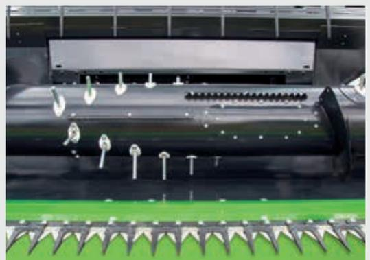
↑ Ampia coclea di alimentazione con dita regolabili a spirale lungo l'intera larghezza di taglio.
