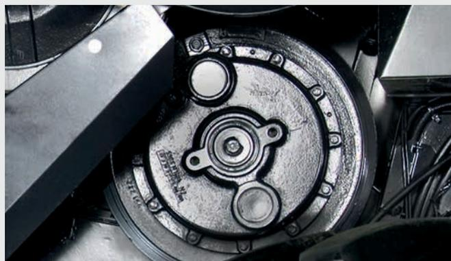
↑ Riduttore opzionale di velocità del battitore da 1250 a 625 giri/min per la velocità massima e da 420 a 210 giri/min per la velocità minima. Questo kit è consigliato per la raccolta del mais.
