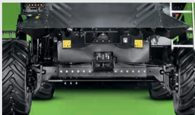
Ponte posteriore regolabile Heavy Duty disponibile anche con esclusivo sistema antislittamento 4RM.
