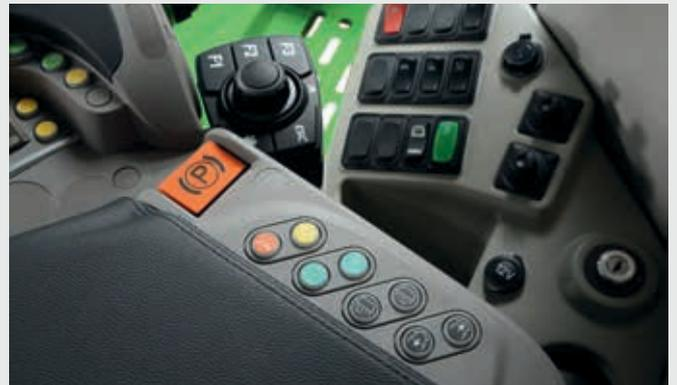
↑ Sulla parte posteriore del bracciolo sono alloggiati i comandi per trazione integrale, freno di stazionamento, apertura serbatoio della granella, MMI e la nuova plancia con prese USB.
