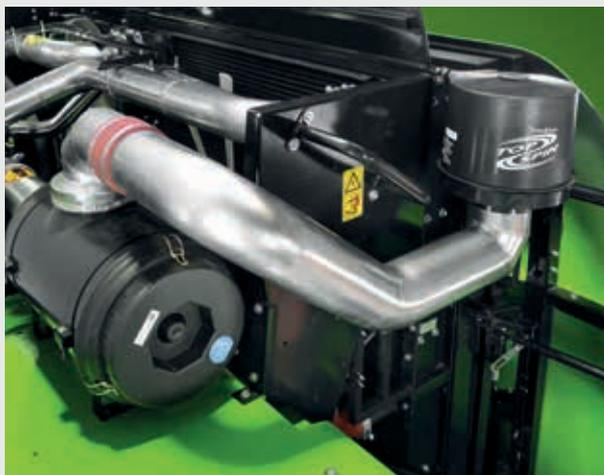
↑ Prefiltro aria motore con sistema autopulente.
