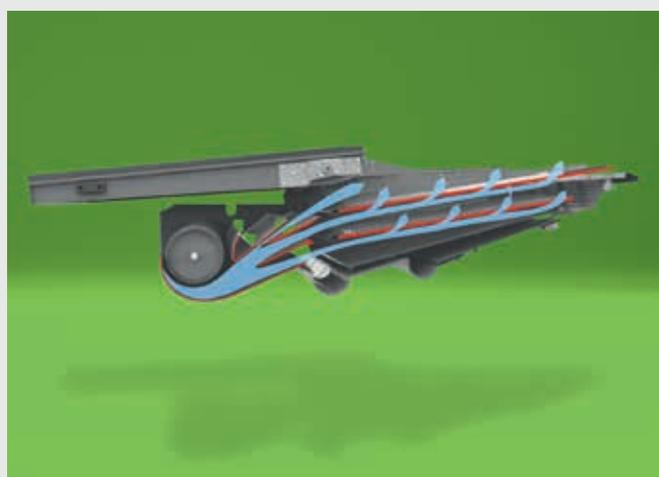
↗ Il sistema di ventilazione turbina raggiunge l'intera area di pulizia e la superficie di separazione.
