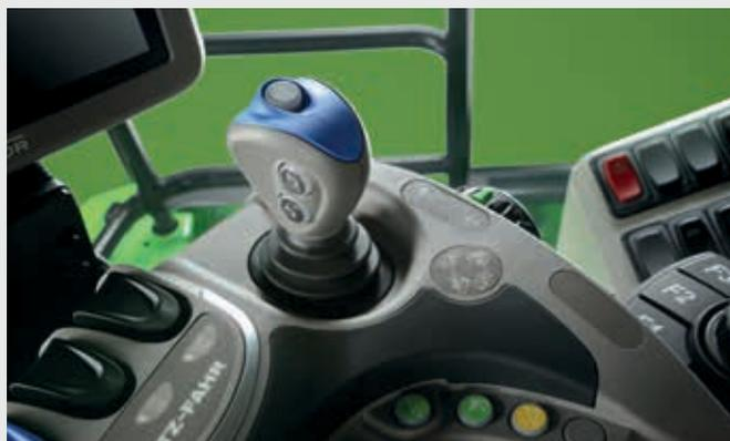
↑ Joystick semplice e intuitivo per il controllo del sistema BALANCE. Funzione automatica e manuale, posizione di neutro e funzione strada. Comoda posizione ergonomica, integrato nel bracciolo di comando.
