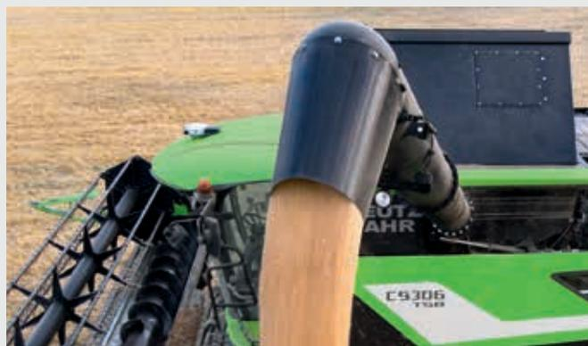
↑ Luce e telecamera integrate sul tubo di scarico per controllare di operazioni di scarico.
