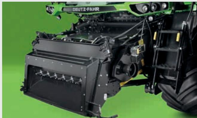
↑ Per tutti i modelli è disponibile un sistema di regolazione elettroidraulica dell'angolo di taglio (di serie sui modelli BALANCE) per ottimizzare la posizione della piattaforma di taglio. La funzione Autocontrol aiuta anche la piattaforma di taglio a seguire le irregolarità del terreno.
