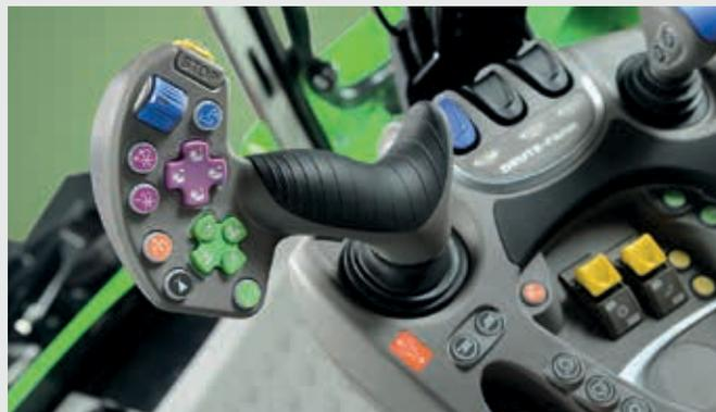
Regolare controllo della trasmissione con il COMMANDER STICK elettronico. La selezione della direzione avviene azionando il pulsante di consenso e spostando la leva nella direzione desiderata. La velocità sarà proporzionale all'entità dello spostamento della leva. Il Cruise control mantiene la velocità di lavoro ottimale, mentre è possibile effettuare lievi correzioni portando il COMMANDER STICK in avanti o all'indietro rispettivamente per aumentare o ridurre la velocità.
