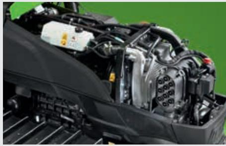
↑ Eficiência compacta. Motores FARMotion com cilindrada otimizada, ventoinha Visco e filtro de ar PowerCore.
