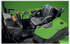
La nueva plataforma del operador: se ha instalado sobre Silent-Blocks para eliminar las vibraciones y es muy ergonómica.
