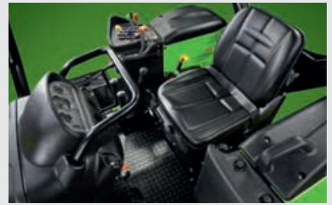
↑ A nova plataforma do operador: eliminação das vibrações graças à montagem no Silent-Block e extremamente ergonómica.
