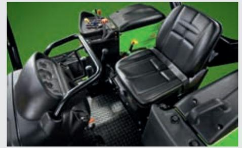
↑ La nuova piattaforma dell'operatore: eliminazione delle vibrazioni grazie al montaggio su Silent-Block ed estremamente ergonomica.
