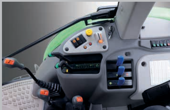
Acoplamiento electrohidráulico para el bloqueo del diferencial de la TDF y la doble tracción
