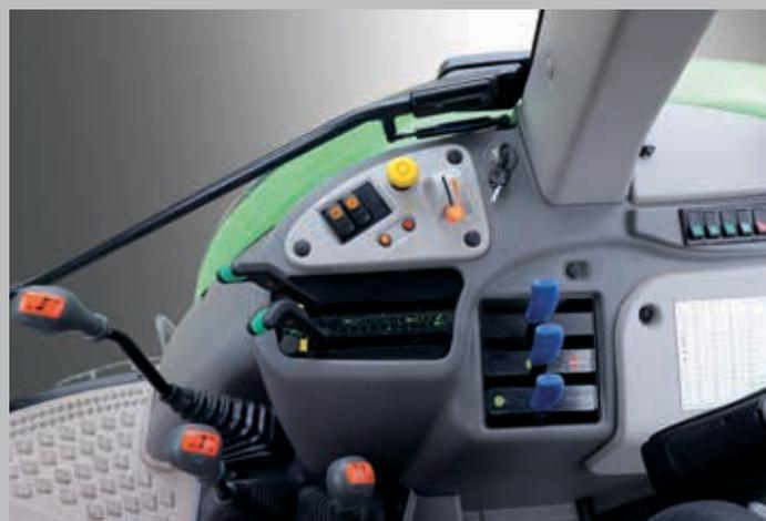
Engagement électrohydraulique 4RM et blocage de différentiel PDF.
