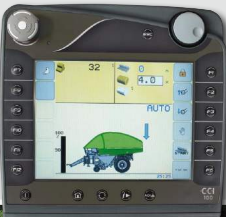
Zwiększenie prędkości obracania beli
