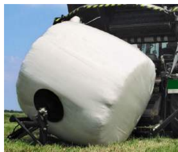
Stawiacz bel, wyładowuje belę płaską stroną na podłożu
