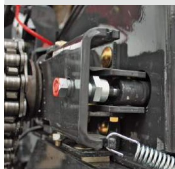
Hydrauliczne sterowanie sprzęgłem rotora
