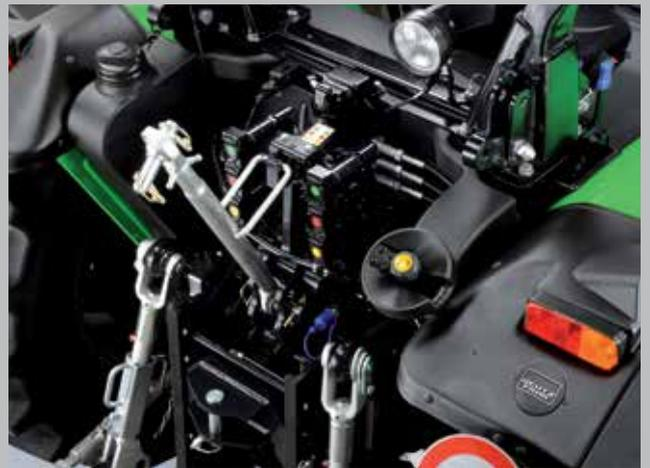
A bomba hidráulica de 55 l/min alimenta até três unidades de controlo traseiras.
