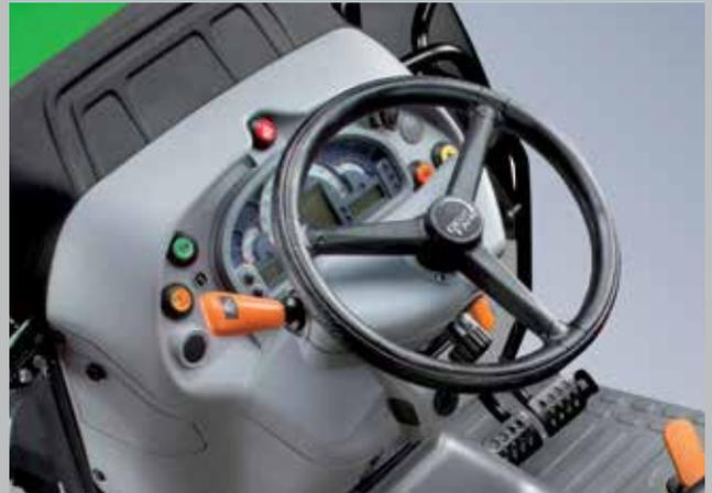
O inovador sistema de direção rápida SDD reduz para metade o número de voltas do volante necessárias para percorrer todo o ângulo de viragem.
