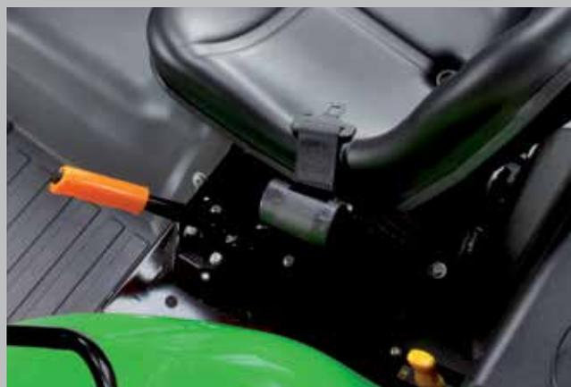
À esquerda do condutor: travão de estacionamento e controlos da TDF.
