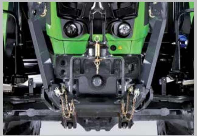
Points d'attelage avant. Capacité de levage de 2 100 kg et PDF 1 000.
