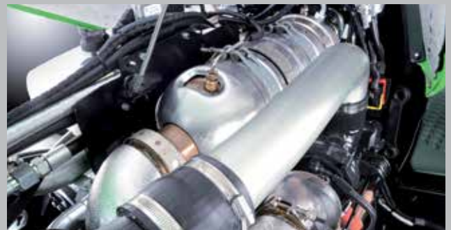
Catalyseur d'oxydation diesel (DOC) garantissent des émissions limitées.
