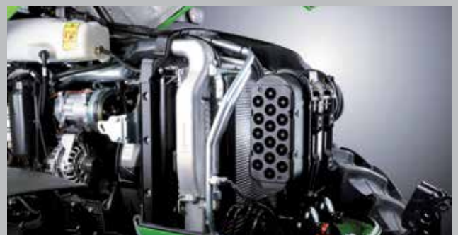
Système de refroidissement facile à nettoyer avec son ventilateur à viscosocoupleur (en option).
