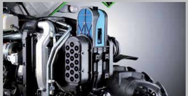
Nouveau filtre à air PowerCore garantit l'efficacité du moteur...
