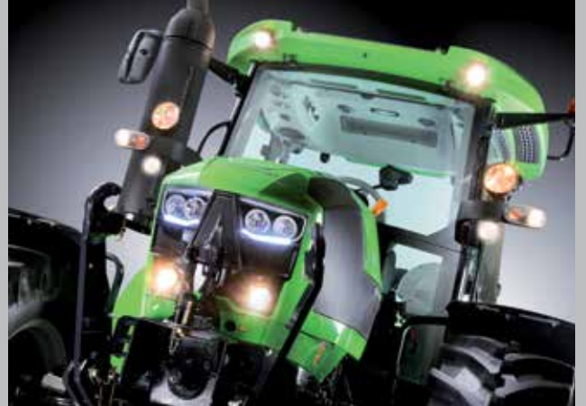
Groupe d'éclairage. Pour une visibilité optimale en cas de mauvaise visibilité. Huit phares de travail sur le toit et les montants latéraux. Deux phares de travail et deux phares à LED sur le capot.
