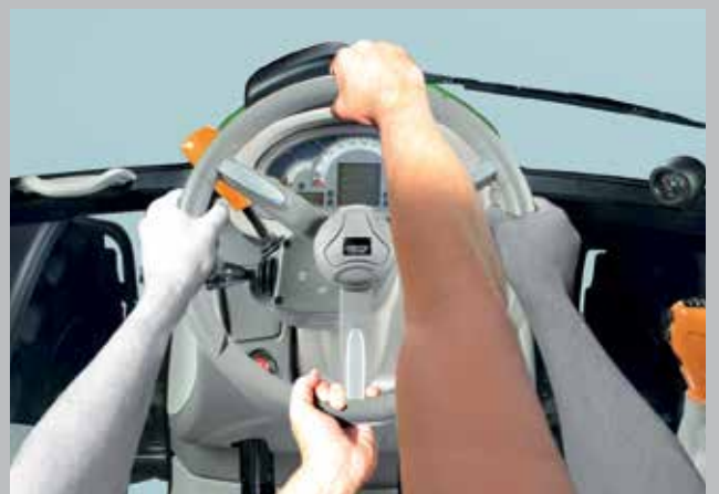
Système de direction rapide SDD. Rotations du volant divisées par deux.
