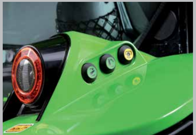
Commandes extérieures de relevage arrière et PDF pour l'installation directe des outils et l'opération extérieure de la PDF.
