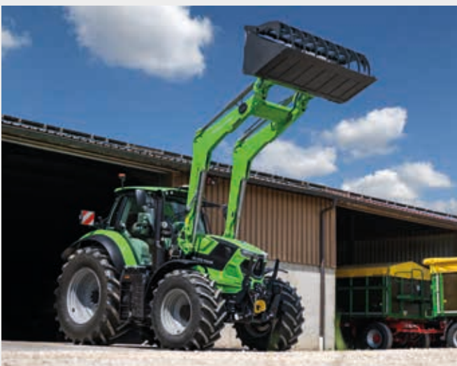
↑ Altura máxima de elevación de 4,5 m y fuerza de arranque de 3.770 daN.
