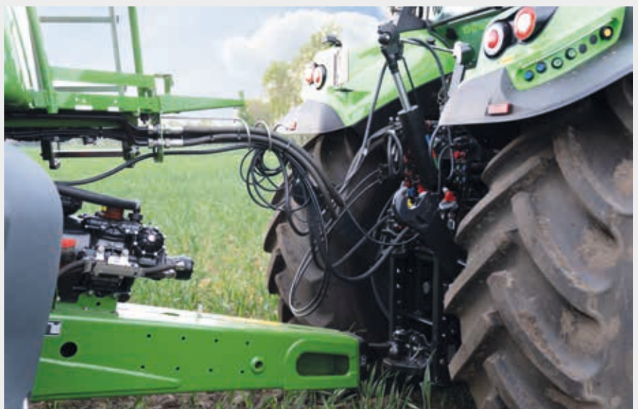
↑ Enganche trasero con posición de transporte para eliminar las interferencias con las barras.
