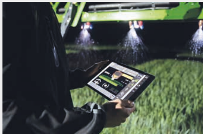
↑ Función XTEND, control de implementos con ISOBUS UT a través de la tableta, estando fuera de la cabina.
