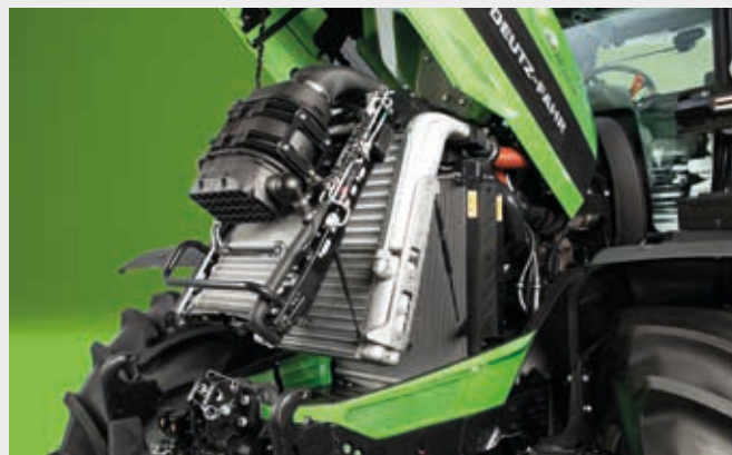
Sistema de refrigeración en aluminio con palanca de acceso, accionable con una mano, y filtro de aire Powercore en el 6210 TTV, 6230 TTV y 6230 TTV HD.
