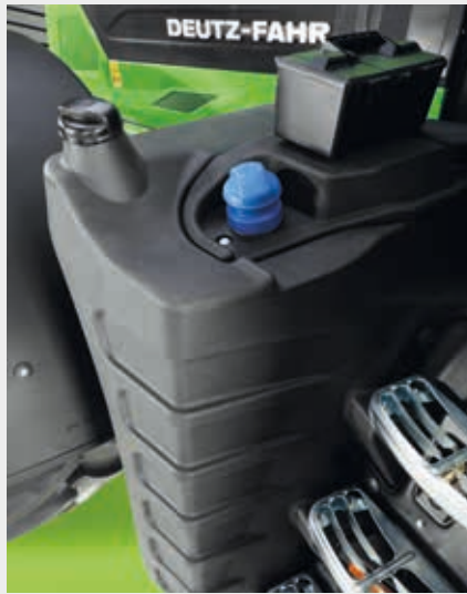
↑ Depósito de combustible de 505 l para garantizar una mayor autonomía.
