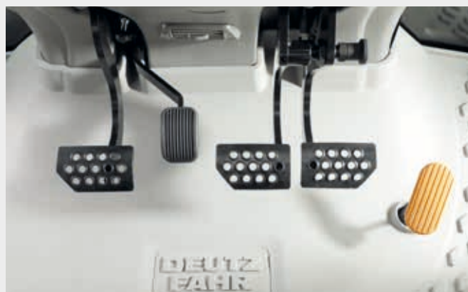
Disposición de los pedales con freno motor Brake PLUS (Pedal adicional entre el embrague y el freno).
