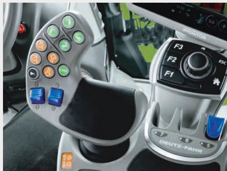
📌 Joystick ergonómico MaxCom con botones de elevación, control del motor y la transmisión, botón para la gestión de las cabezeras y dos distribuidores hidráulicos proporcionales.
