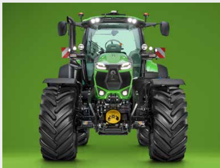
La TDF frontal DualSpeed lleva un eje estriado desmontable, para poder conectar el tractor a implementos con ejes de cualquier tipo.
