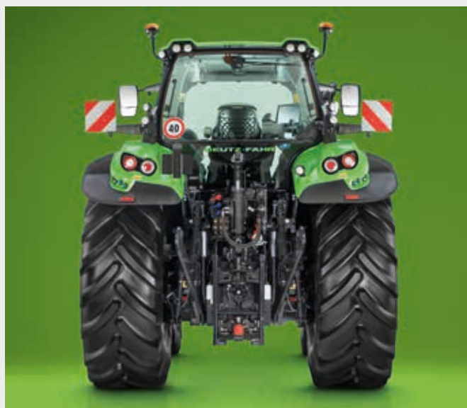
El sistema "Clean Oil" suministra hasta 90 litros de aceite a los implementos y garantiza el menor coste de mantenimiento gracias a los intervalos de cambio de 2.000 h o 2 años.
