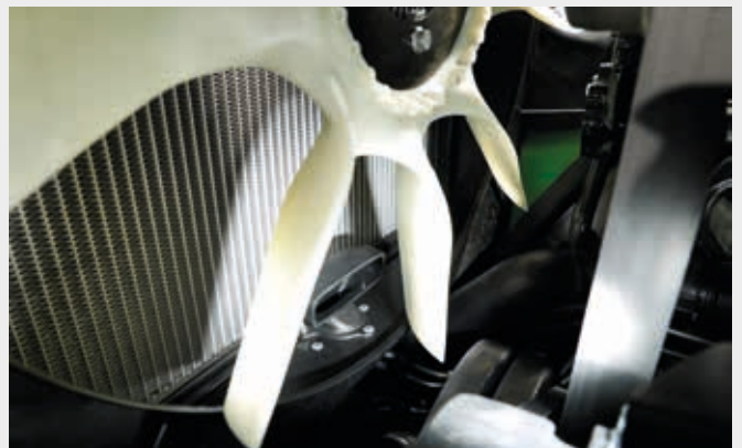
Ventilador electrónico con acoplamiento viscoso (eVisco) y conducto de aspiración para el sistema de prelimpieza del filtro de aire (elimina el 95% de las partículas gruesas antes de que lleguen a los filtros).
