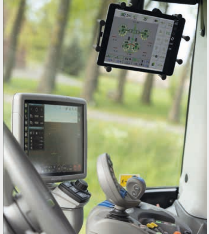
La función XTEND permite ver el SDF Guidance o controlar un aparato ISOBUS en un dispositivo externo, por ejemplo, una tableta.
