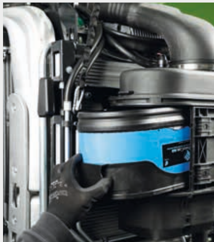
↑ Filtro de aire con unidad de prelimpieza.
