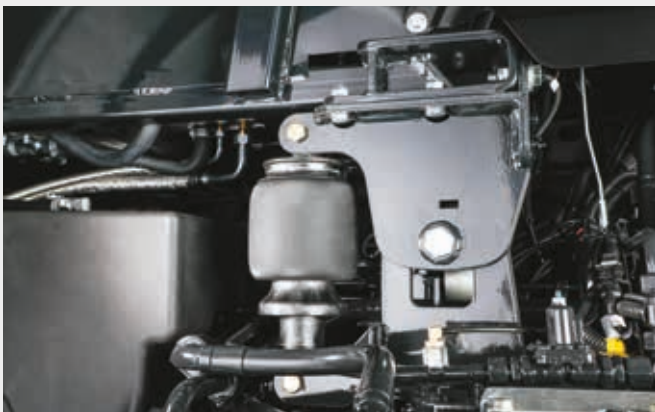
↑ Elementos de la suspensión neumática de la cabina.
