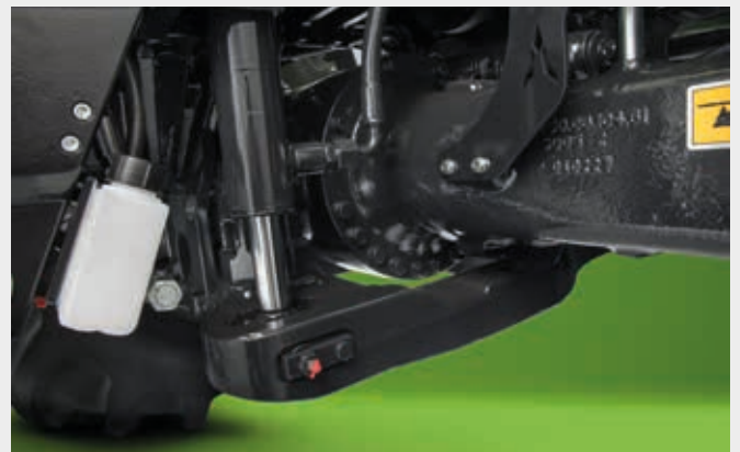
↑ Eje delantero del 6190 TTV con un robusto brazo inferior oscilante.
